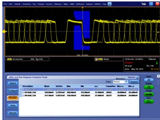
MOST150过冲和下冲的测量结果
