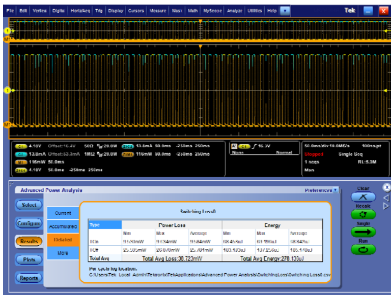
DPOPWR 开关损耗测试
