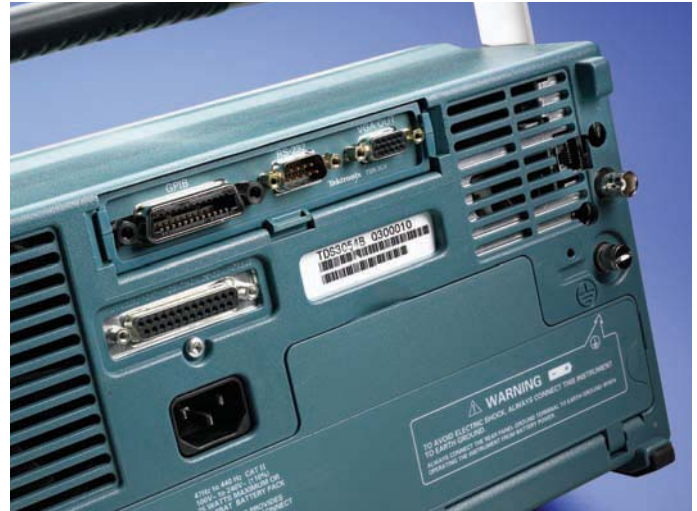
그림 53. 오늘날의 오실로스코프는 표준 Centronics 포트와 옵션 이더넷/RS-232, GPIB/RS-232 및 VGA/RS-232 모듈과 같은 광범위한 통신 인터페이스를 제공합니다. 또한 전면부에 USB 포트(그림에는 나와 있지 않음)도 있습니다
