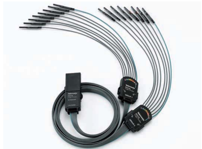
그림 43. MSO(혼합 신호 오실로스코프)용 로직 프로브를 활용하면 장치에 대한 디지털 연결을 간소화할 수 있습니다.
