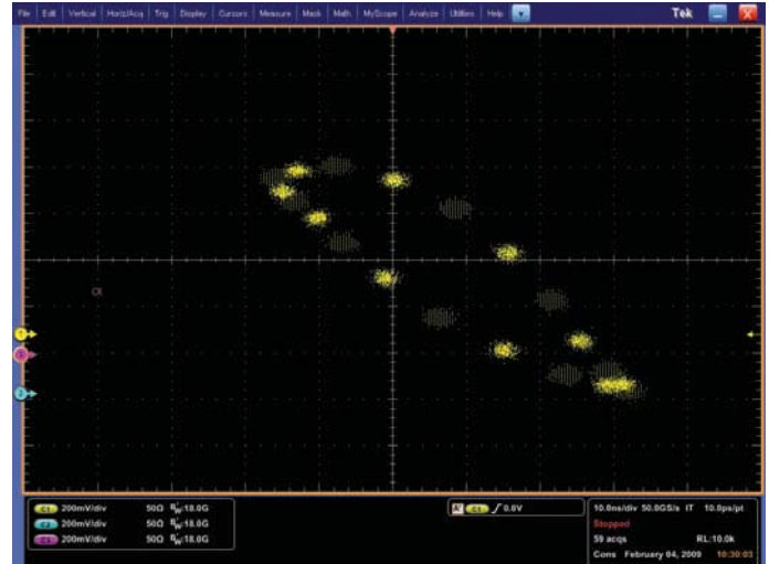
그림 3. Z축 명암 그레이딩이 적용된 2개의 오프셋 클럭 패턴
