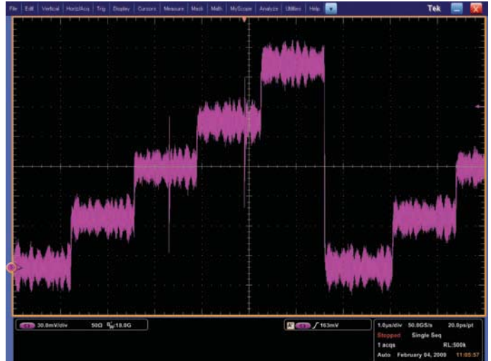
그림 24. 미세한 이상 신호도 캡처할 수 있는 오실로스코프의 피크 탐지 모드
