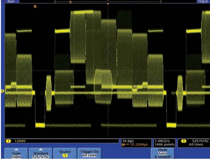
그림 6. NTSC 컴포지트 비디오 신호 - 복합파의 예
