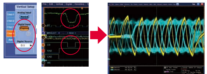
例) iCapture機能を使い、デジタル接続のD3をアナログ観測
