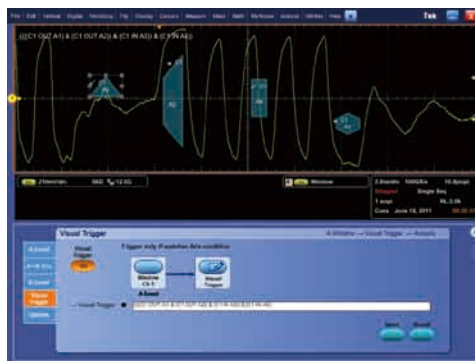
DDR信号へのトリガ例
