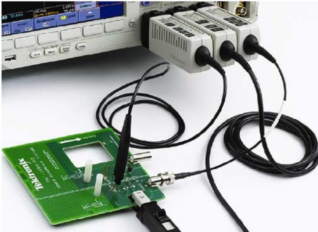
그림 7. 텍트로닉스 디스크 펄스 발생기 및 디스크 픽스처
