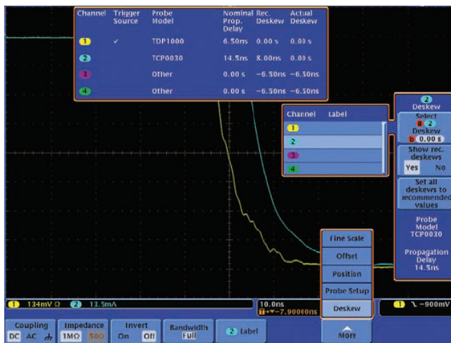
圖 5. 電壓與電流探棒間的預設時脈偏移
