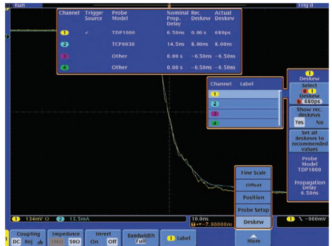
圖 8. 手動消除電壓探棒與電流探棒間的時脈偏移
