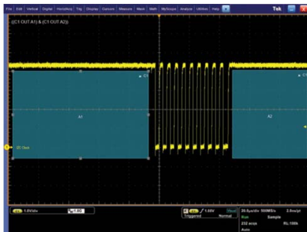
图 3. 突发宽度可视触发。
