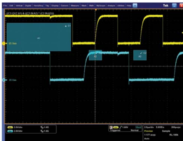
图 6. 可视触发捕获 10 串行数据码型。
