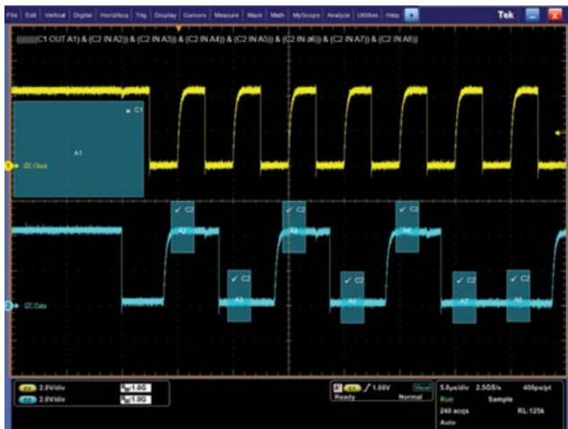
图 4. 101 0100 I 2 C 串行数据码型上的串行触发。
