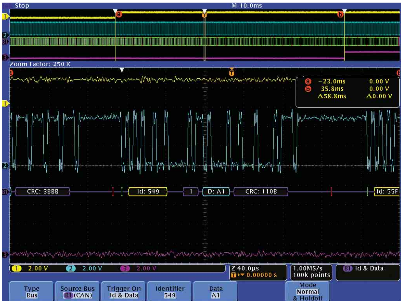
図3. CANバスにおいて待ち時間測定のためにマーカを設定した例
