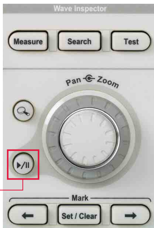
図2A. 専用ボタンによる波形の自動再生／停止
