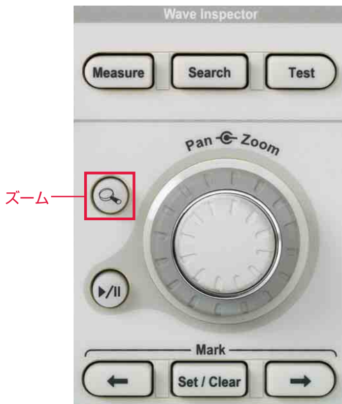
図1A. ズーム／パンのための専用操作部
