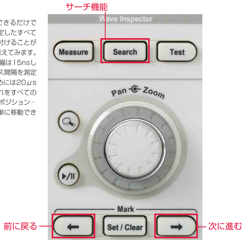
図3A. Wave Inspectorの強力なサーチ機能により、ユーザが定義したすべての条件に合致したイベントを検出できる
