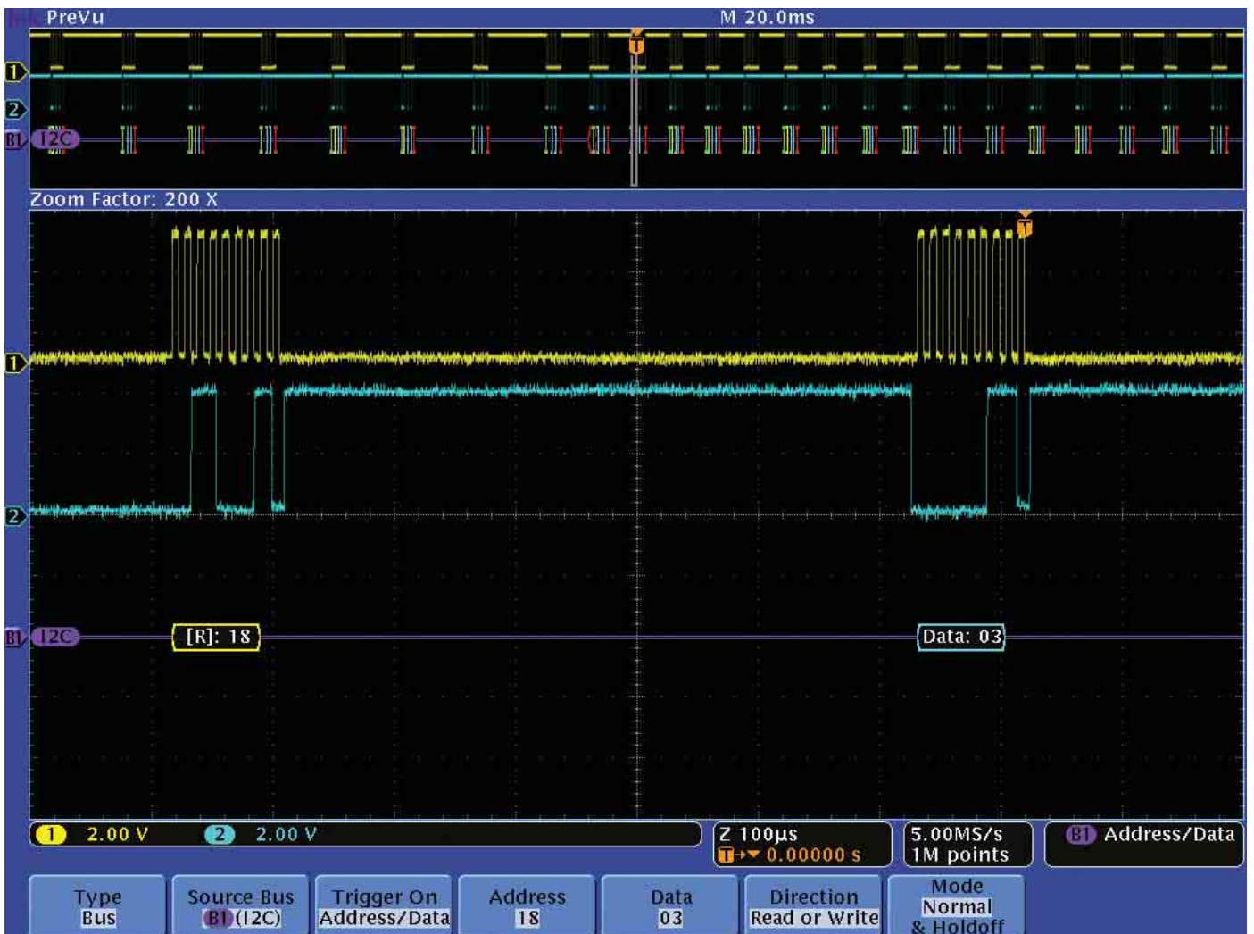
図2. I 2 Cバスの長いアキュイジションを簡単に観測できる
