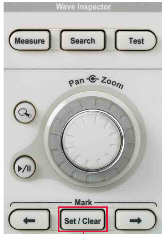
図2B. 専用ボタンによるマーカのセット/クリア、マーカ間の移動
