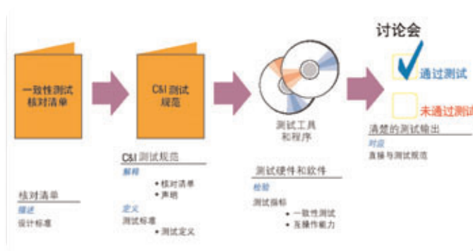
► 图 8. PCI-SIG 一致性和互操作能力测试流程
