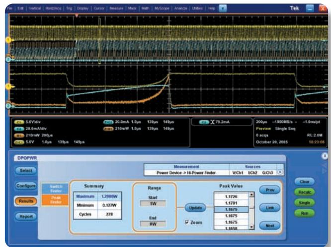
▶ 図8：負荷が変化するスイッチング・デバイスの電力波形解析例 (HiPower Finderとオシロスコープのズーム機能を使用)。
