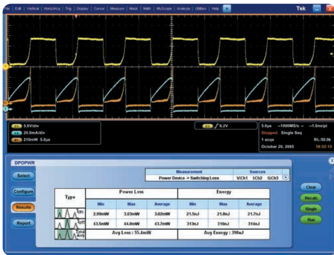
▶ 図7：スイッチング・デバイスのターンオン期間における最小、最大、平均の電力損失をDPOWPRで測定
