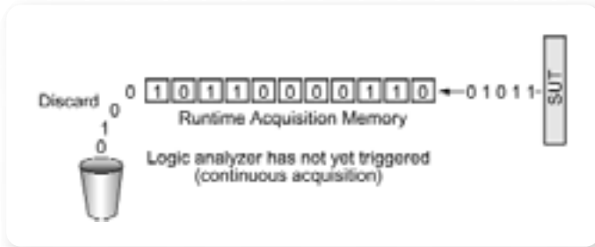
▶ 그림 11. 로직 애널리저는 트리거 이벤트가 발생할 때까지 처음 들어온 데이터를 처음 내보내는 방식으로 데이터를 캡처하고 버립니다.
