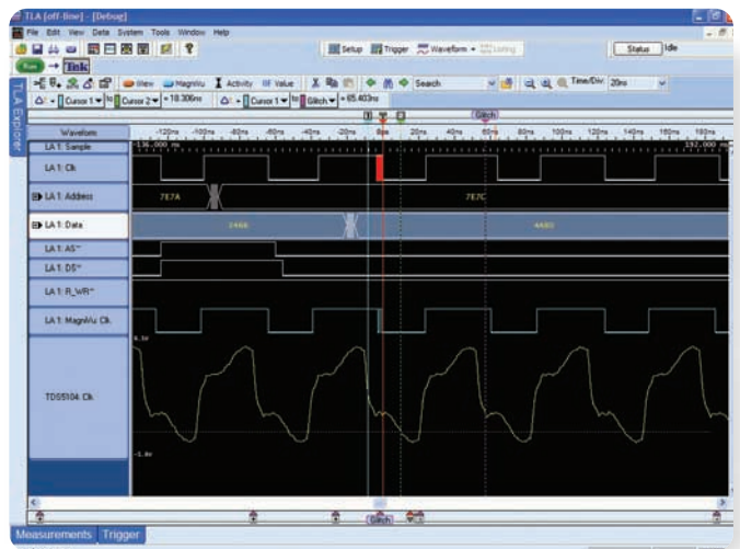
▶ 図14：MagniVu®アキュイジションにより、クロック信号のグリッチを検出
