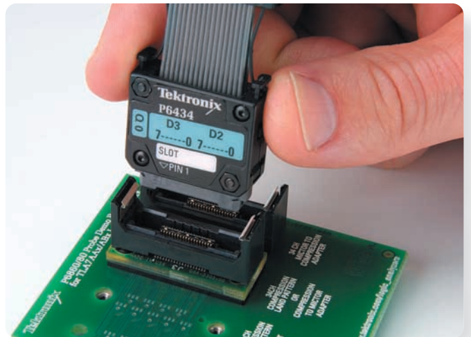
▶ 図5: 高実装密度、多チャンネル・ロジック・アナライザ・プローブ
