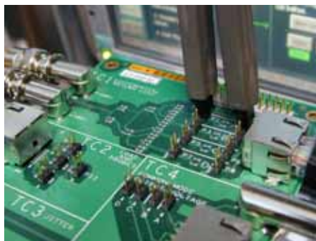
図 10. テスト・フィクスチャのリターン・ロス測定回路に接続された差動プローブ
