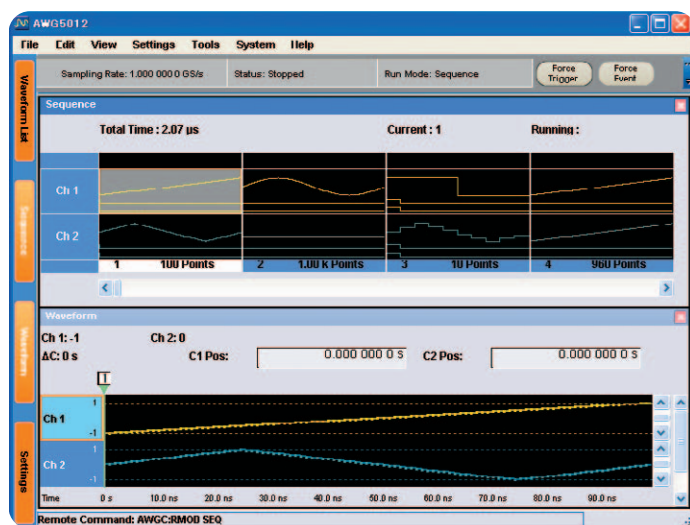
▶ 図 33. グラフィック・エディタとシーケンス・エディタ。この2つが組み合わされていることで、波形を柔軟に作成することができます。
