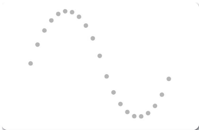
▶ 図 17. 正弦波を表す一連のサンプル・ポイント（左）と、再現された正弦波（右）。
