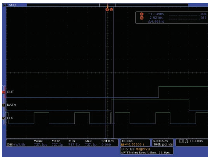
図17. MSOで捉えた727.3psのクロック・グリッチ
