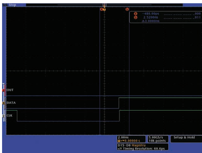
図22. クロックの立上りエッジ周辺に設定したカーソルA/B間のDフリップ・フロップのセットアップ/ホールド時間ウィンドウにおけるデータの変化にトリガした様子
