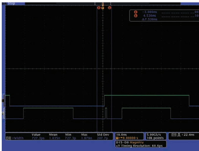
図13. 下に表示されているLVPECL信号の727.3psのグリッチにトリガした例
