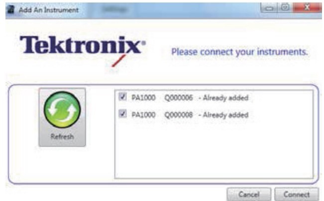
图 19. 通过 PWRVIEW 连接的两台 PA1000 实例。
