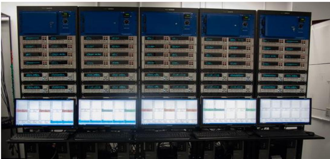
176通道超高精度库伦效率测试系统, 精度高达0.001%
