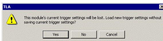
図 2-69 : 新たなトリガ設定を読み込むにあたって、現在のトリガ設定を保存するか、廃棄するかの判断を求める TLA ダイアログ・ボックス
