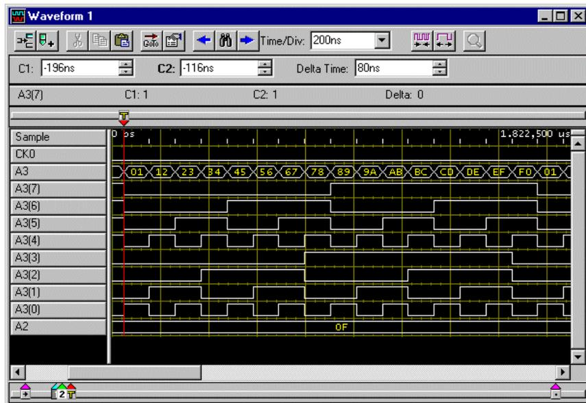
図 3-66 : 正常なデータとしてのウエーブフォーム・ビュー (ウィンドウ・サイズを最適化し、A3 グループの個々の信号を同時に表示しています)
