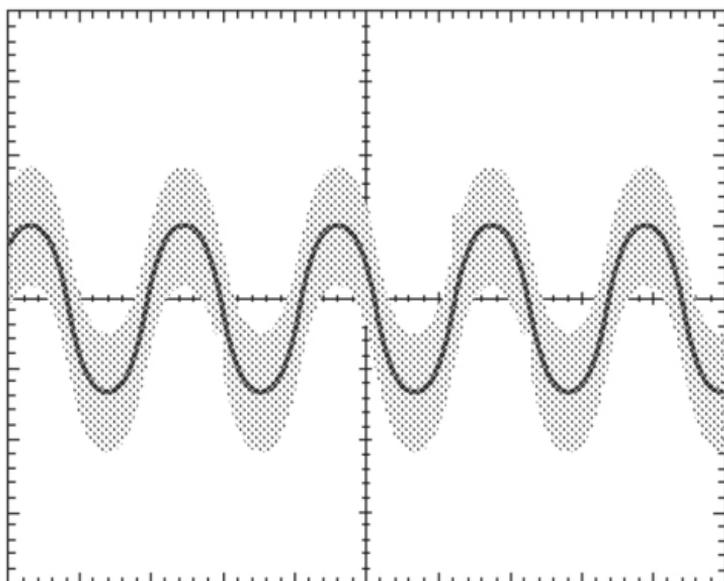
템플릿 파형의 엔벨로프를 초과하는 활성 파형은 한계 테스트 파형을 위반한 것으로 오실로스코프에 강조 표시됩니다. 오실로스코프가 한계 테스트를 중단하고 경고음을 울려 한계 테스트 위반에 응답할 수 있도록 설정할 수 있습니다. 다음 그림은 한계 테스트 엔벨로프를 초과한 활성 파형으로 강조 표시되어(검정색) 보여줍니다.
