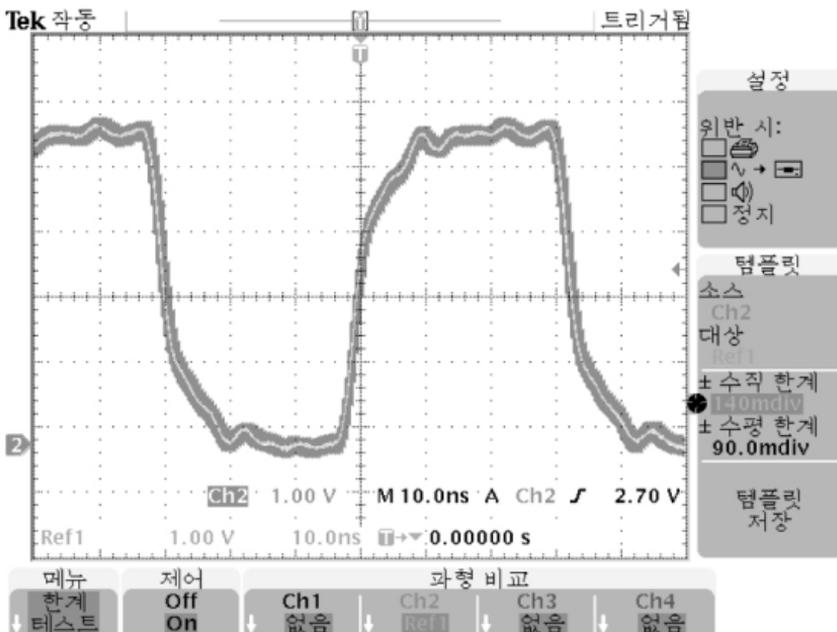
애플리케이션 메뉴에는 모든 한계 테스트 제어와 설정을 할 수 있는 여러 하단 및 사이드 메뉴 항목이 들어 있습니다. 메뉴 항목에는 각 메뉴 항목의 기능을 더욱 자세하게 설명하는 문자나 그래픽이 들어 있습니다.
