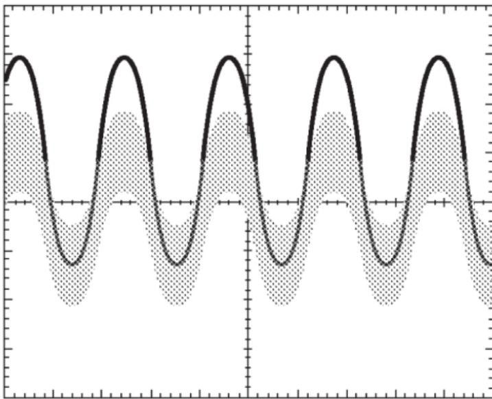
템플릿은 샘플 지점의 최소/최대 쌍으로 구성되는 엔벨로프 파형입니다. 500포인트 소스 파형으로 만들어진 템플릿 엔벨로프 파형에는 250개의 최소/최대 쌍을 포함합니다. 10K 포인트 파형으로 만들어진 템플릿 엔벨로프 파형에는 5000개의 최소/최대 쌍을 포함합니다.
