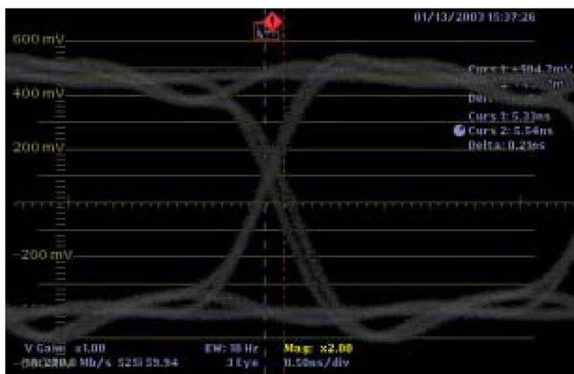
図 3-9：タイミング・ジッタを測定する場合のタイミング・カーソルの配置
