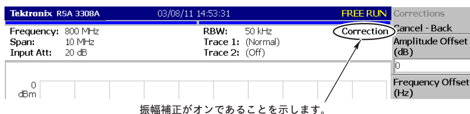
図 4-97 : 振幅補正のセットアップ表示
