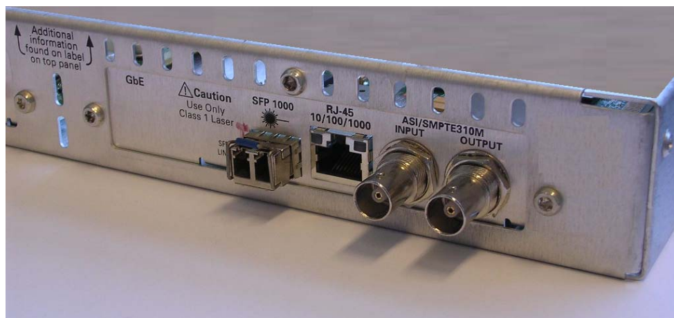
図 B-6 : SFP モジュール - 取り付け
