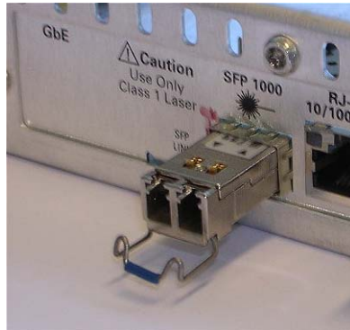
図 B-5 : SFP モジュール - 取り外し
