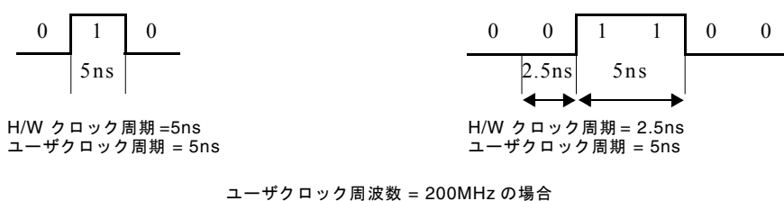
図 2-36 : クロックパターンの引き伸ばしと H/W クロックの高速化
