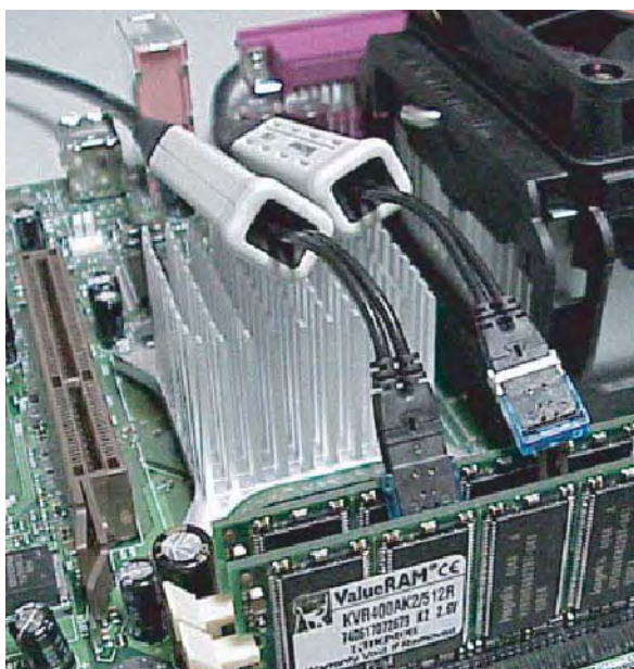
图 10：焊接 Tip-Clip 组件
