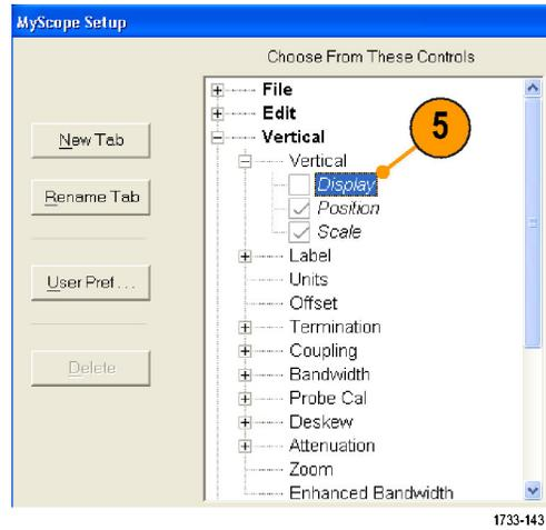
6. 单击控件，并将其拖到 MyScope 控制窗口中。释放鼠标后，控件会对齐到最近的栅格位置上。通过单击并拖动控件，可以改变控件在 MyScope 控制窗口中的位置。
