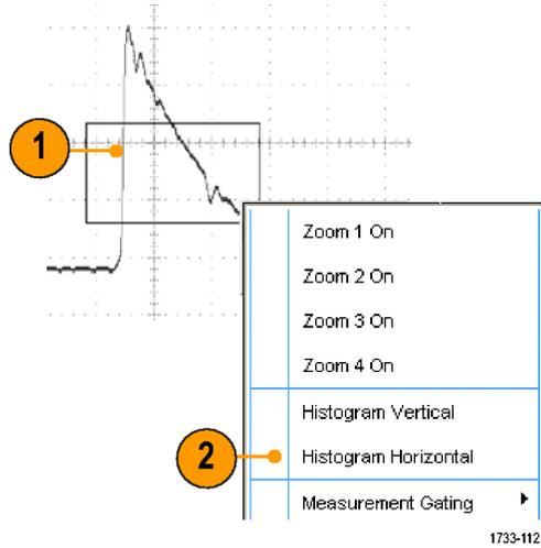
3. 查看在刻度的顶部（对于水平直方图）或左边沿（对于垂直直方图）的直方图。
