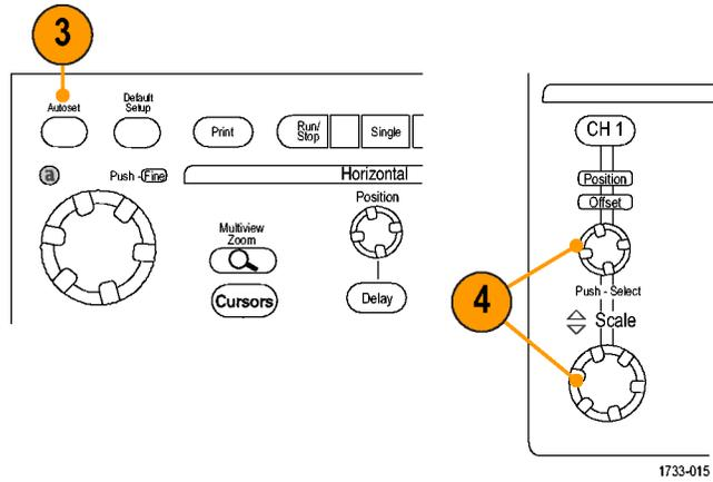
5. 使用前面板上的旋钮调整水平位置和刻度。
