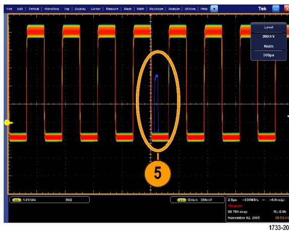
6. 要触发在步骤 5 中标识的毛刺，请选择 **Glitch Setup...**（毛刺设置...）。
