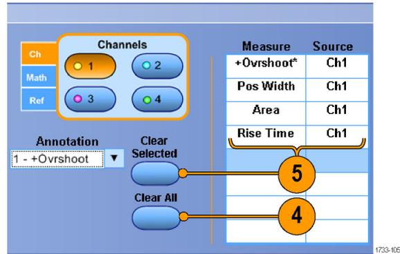
还可以直接在 Measure（测量）菜单中为所选波形选择测量。（见第58页，*自动测量选项*）
