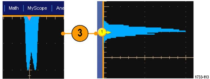
4. 要对直方图的比例或直方图框的大小和位置进行调整，请选择 **Measure (测量) > Waveform Histograms (波形直方图)**，然后使用 Histogram Setup (直方图设置) 控制窗口。
