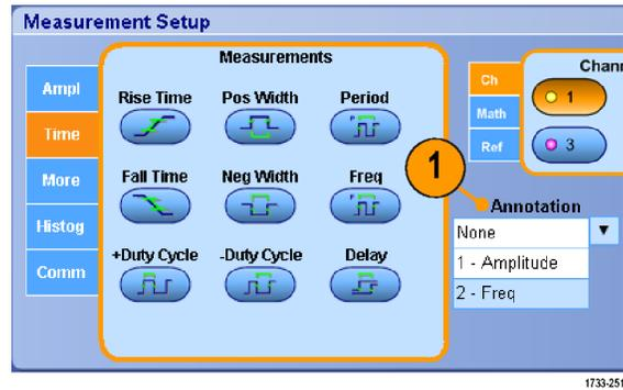
2. 要选择测量标注细节，请选择 **Measure > Annotation > Standard**（测量 > 标注 > 标准）或 **Detailed**（细节）。
