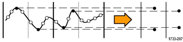
**Hi Res 模式**为每个采集间隔计算所有取样的平均值。Hi-Res 提供了较高分辨率、较低带宽的波形。
