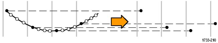
**峰值检测模式**使用两次连续采集间隔中包含的所有取样的最高点和最低点。该模式仅可用于实时、非内插的取样，并在捕获高频率的毛刺方面非常有用。
