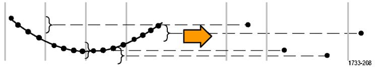
**包络模式**在许多采集点中查找最高记录点和最低记录点。包络模式对每个单独的采集使用“峰值检测”。
