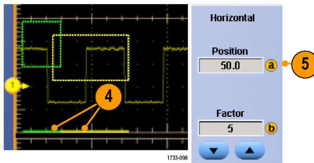
6. 要在垂直方向调整缩放区域，请选择 **Vertical**（垂直）> **Zoom Setup...**（缩放设置...），单击某个垂直场，然后使用多功能旋钮来调整 **Vertical Position**（垂直位置）和 **Factor**（因数）。
