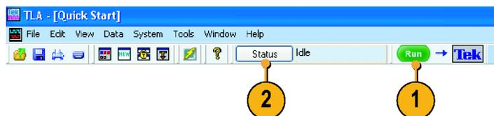
2. 機器がトリガされない場合は、Status (ステータス) をクリックします。ダイアログ・ボックスの情報を参照して、ロジック・アナライザがトリガ待機の状態であるか、あるいはトリガはされたがアクイジション・メモリがいっぱいであるかを確認します。
