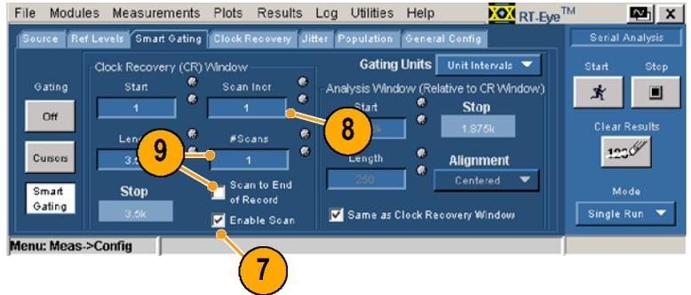
**设置分析窗口。** 设置时间恢复窗口后，必须设置分析窗口。有三种方法可设置分析窗口。
