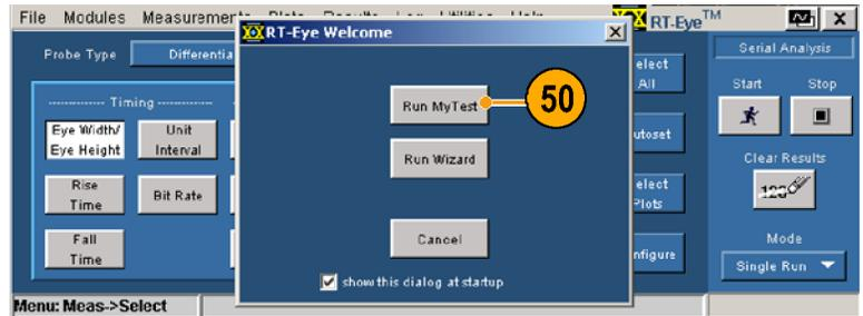
51. 如果未出现 RT-Eye Welcome (RT-Eye 欢迎) 对话框，那么选择 **Measurements (测量) > Run MyTest (运行 MyTest)**。
