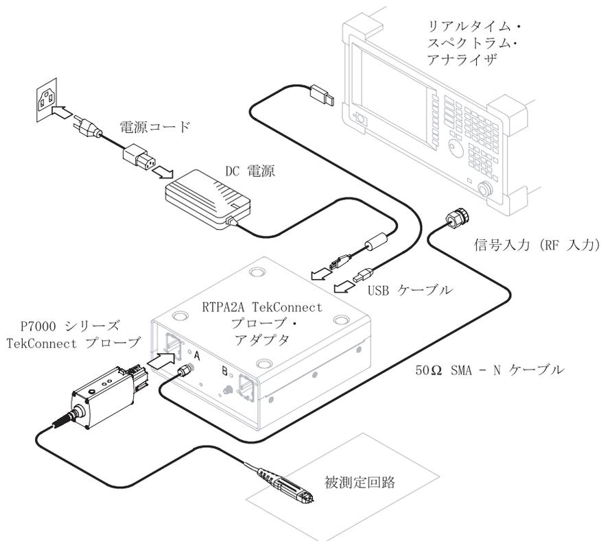
IおよびQ セットアップ - 下の図に従って接続します RF セットアップは
