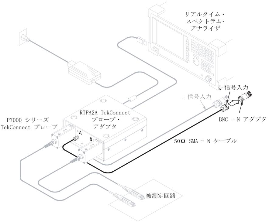
**RF および I セットアップ** - 下の図に従って接続します RF セットアップはグレイで示されています。
