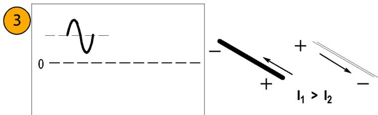
4. 要调节电流零点，可以调节其中一根导线中的电流直到显示测量值为零。
