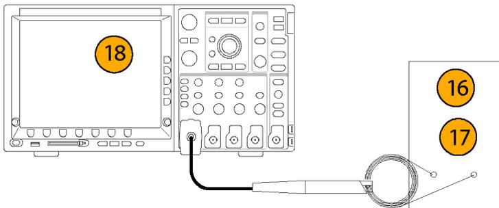
19. 使用 18 步中测到的波形幅度 (c) 和 7 步中测到的示波器直流增益精度值 (b), 计算探头直流增益精度 (d)。
