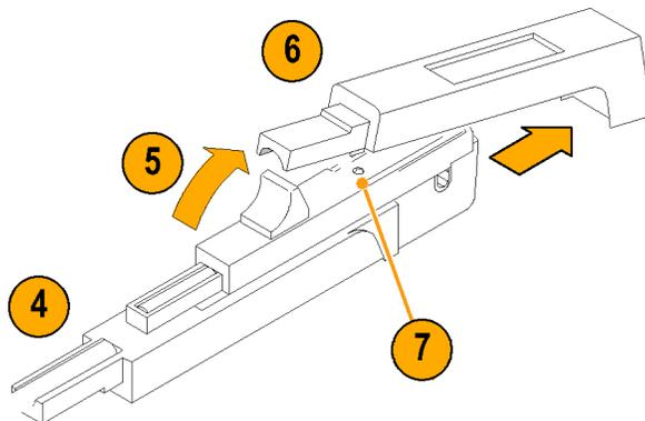
8. 将探头倒置，将滑块轻轻向后推，然后取下滑块。
