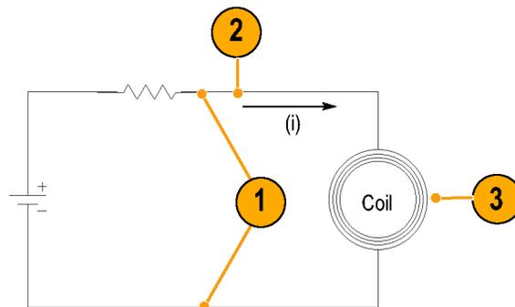
要得到更精确的圈数，需要一个已知圈数的线圈作为参考。执行如下操作：
