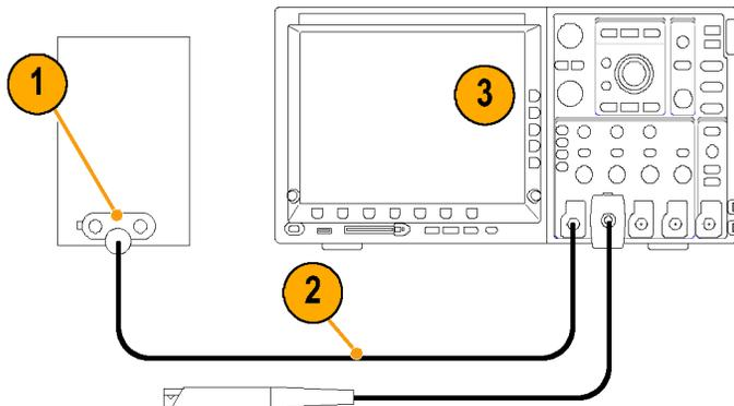
4. 将校准器设置为 1.5 Vpk (3.0 Vp-p) @500 Hz 方波。
