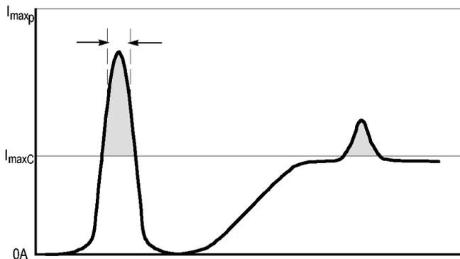
**说明：** 在测量了超过探头的最大额定连续电流、最大额定脉冲电流或额定安培-秒乘积的电流后，必须对探头进行消磁。超过这些额定值会磁化探头并导致测量错误。
