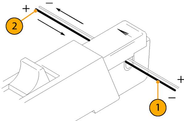
**说明：** 将辅助导线添加到探头中增加了插入阻抗并降低了探头的带宽限制上限。缠绕多圈进一步增加插入阻抗，从而进一步降低带宽上限。
