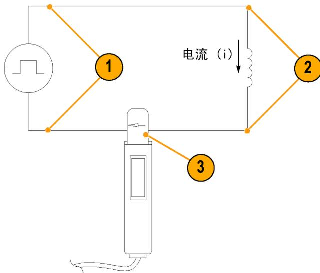
4. 测量电流锯齿波。电感由此处显示的电流锯齿波的斜率进行有效定义。
