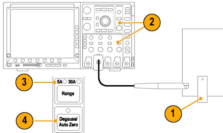
7. 将电流探头环 HF 电流回路夹住。
