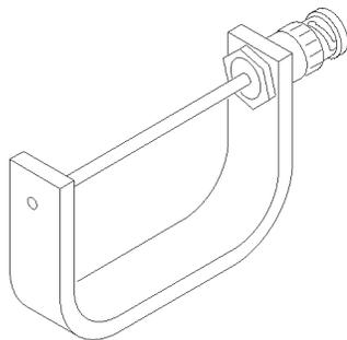
1. 将电流回路连接到电流源。
