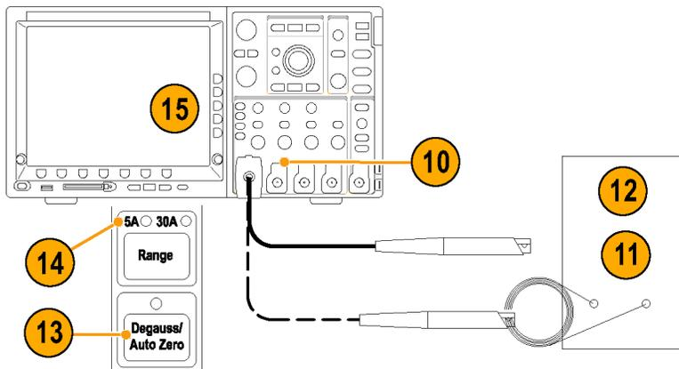
16. 设置校准器输出 500 Hz 方波到 5 圈电流回路中。
