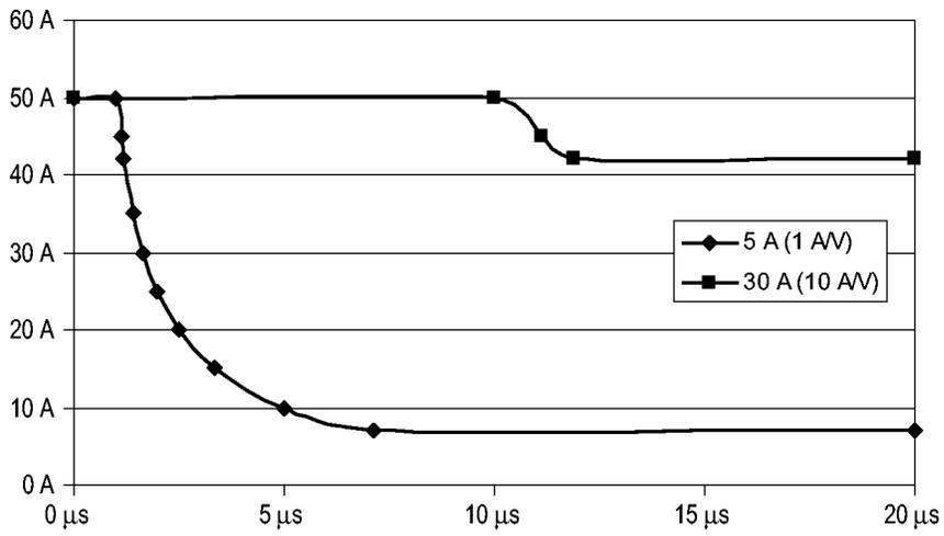
图 3: 最大峰值脉冲与脉冲宽度关系
