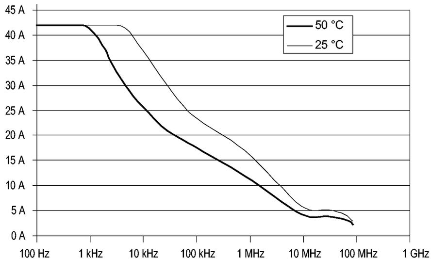
图 1: 频率下降 (峰值电流与频率关系)
