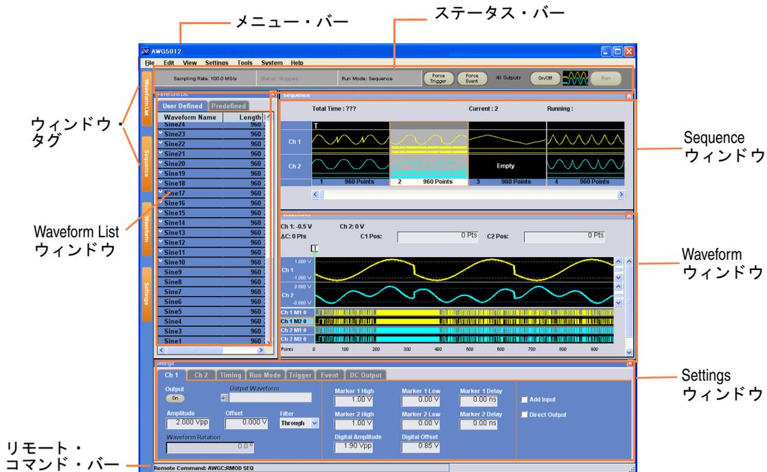
**メニュー・バー**. メニュー・バーから機器のすべての機能にアクセスできます。メニュー項目を選択すると、対応するコントロール・ウィンドウ (ダイアログ・ボックス) が表示されるか、または選択したメニュー項目がただちに実行されます。
