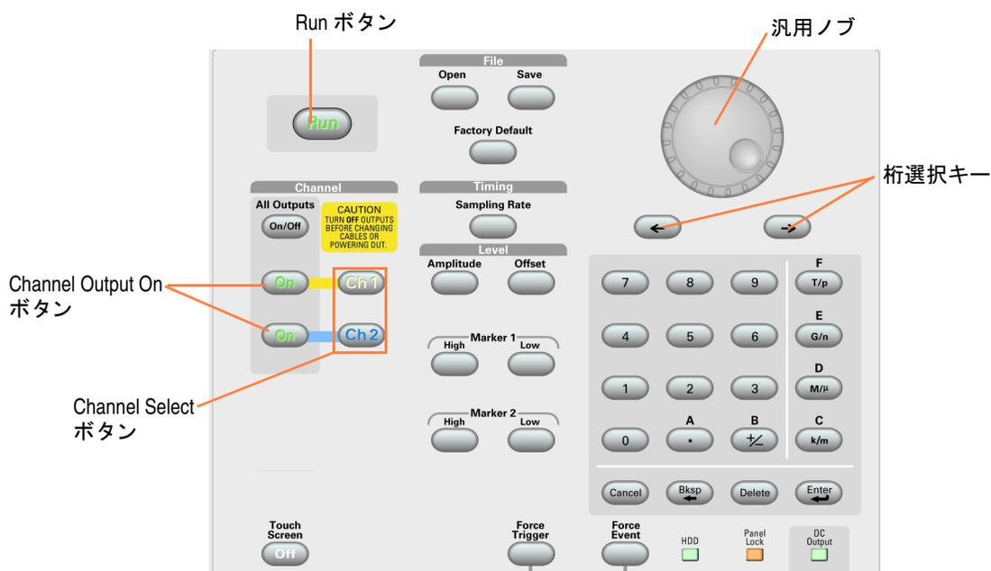
**Run.** Run ボタンは信号発生動作の開始 / 停止をコントロールします。信号が発生しているときは LED が点灯します。実際に出力コネクタから信号を出力させるには、前面パネルの All Outputs On/Off ボタン、または Channel Output On ボタンを押して出力をイネーブルにする必要があります。
