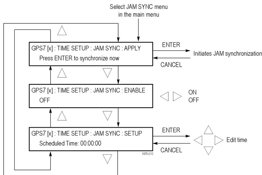
**Figure 3-66: GPS7 module JAM SYNC submenu**
