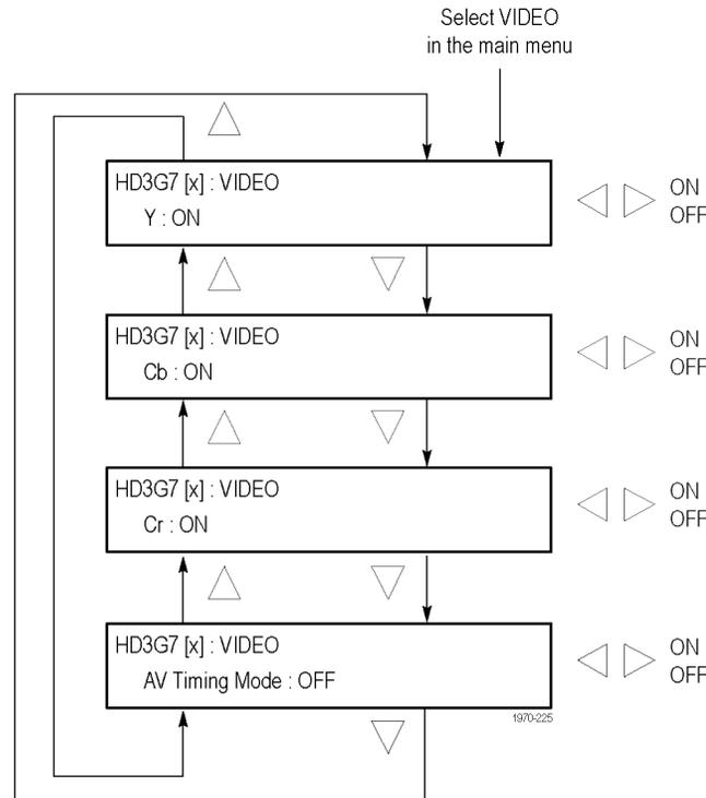
**Figure 3-90: HD3G7 module VIDEO submenu**
