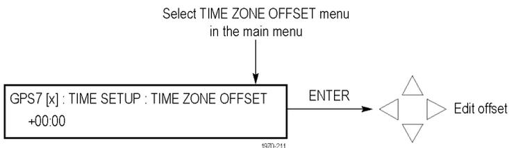
**Figure 3-63: GPS7 module TIME ZONE OFFSET submenu**
