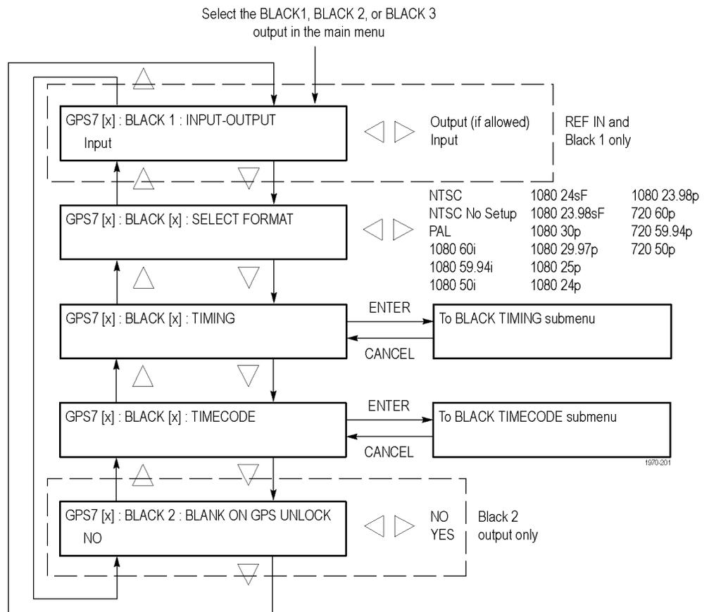
**Figure 3-57: GPS7 module BLACK submenu**
