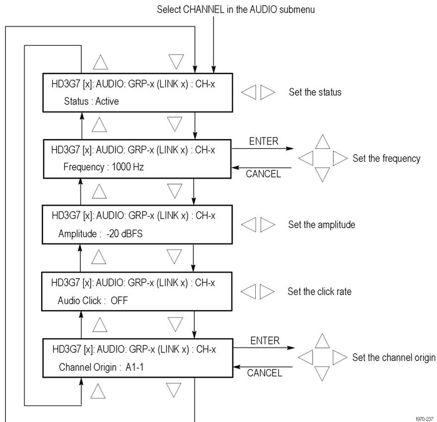
**Figure 3-87: HD3G7 module AUDIO : CHANNEL submenu**
