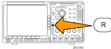
2. В нижнем экранном меню нажмите кнопку **R1, R2, R3** или **R4**, чтобы удалить опорную осциллограмму с экрана.
