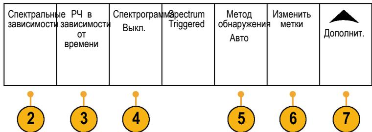
3. Нажмите **РЧ в зависимости от времени**, чтобы вызвать боковое меню трех типов зависимостей РЧ от времени, которые может отображать осциллограф MDO4000.
