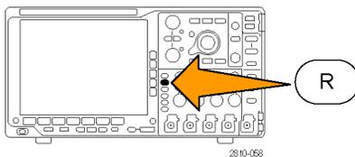
2. Используйте нижнее меню для выбора или отображения опорной осциллограммы или зависимости.
