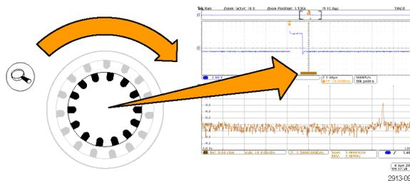
С помощью элементов управления масштабам можно более пристально рассмотреть интервал регистрации аналогового сигнала и представление сигнала в частотной и временной области с корреляцией по времени.
