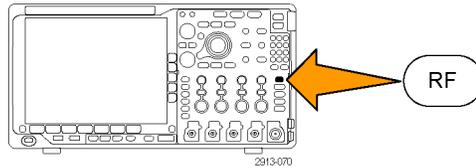
2. Нажмите **Спектральные зависимости**, чтобы вызвать боковое меню четырех типов спектральных зависимостей, которые может отображать осциллограф MDO4000.
