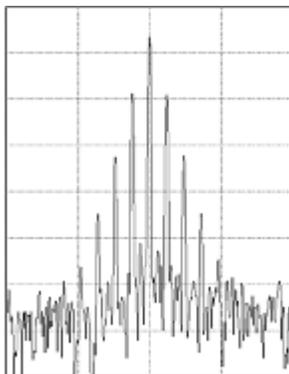
Меньшие значения RBW (узкая полоса) требуют большего времени обработки, однако дают более высокое разрешение и меньший уровень шума.
