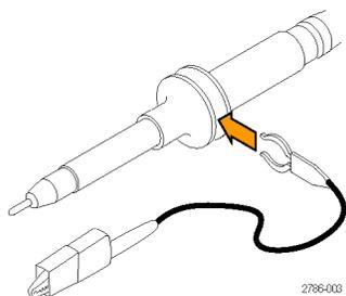
**Провод заземления с зажимом типа «крокодил»**
