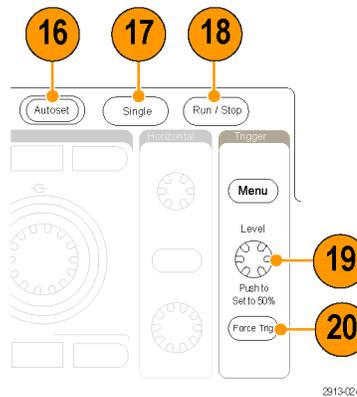
**19. Уровень (в группе «Запуск»).** Поверните, чтобы установить уровень синхронизации. Нажмите, чтобы установить значение уровня синхронизации равным половине амплитуды сигнала.
