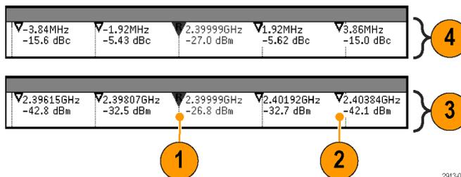
На снимке экрана ниже изображены маркеры, помещенные в области явных пиков. Опорным маркером отмечен наибольший пик. Этот маркер имеет вид буквы R в красном треугольнике. Числовые показания для данного маркера также выделены красным цветом.
