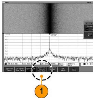
2. Когда отображается только частотная область, можно выбрать между отображением синхронизированных и несинхронизированных спектрограмм (режим «свободного пуска»). При выборе варианта без синхронизации осциллограф захватывает спектр настолько быстро, насколько возможно.
