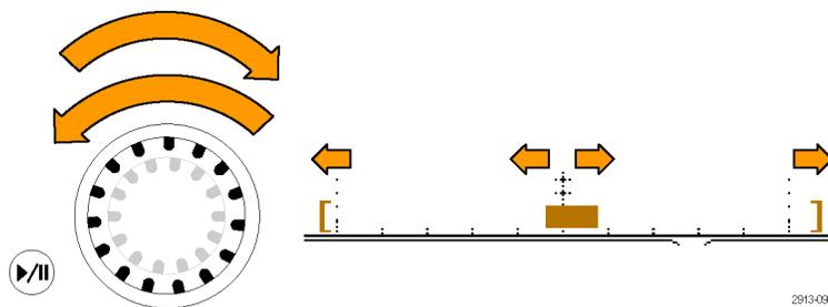
При повороте ручки панорамирования по часовой стрелке интервал регистрации РЧ-сигнала и временное положение спектра смещаются вправо. Когда правая граница интервала регистрации РЧ-сигнала достигает правого края экрана, сдвигать этот интервал дальше невозможно.
