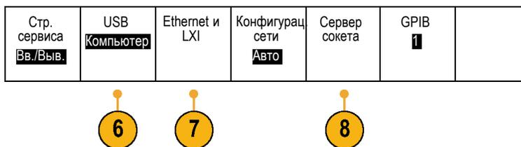
7. Для использования Ethernet нажмите в нижнем меню кнопку **Ethernet и LXI**.
