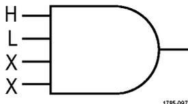
Синхронизация выполняется, когда все каналы переходят в выбранное состояние. С помощью многофункционального регулятора **A** выберите канал. Нажмите соответствующую кнопку в боковом экранном меню, чтобы установить для данного канала состояние **Высокое (H)**, **Низкое (L)** или **Безразличное (X)**.
