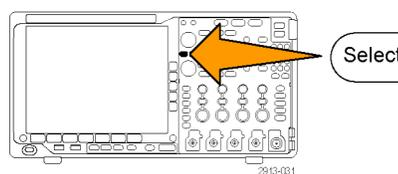
3. Кнопка **Точно** предназначена для переключения грубой и точной настройки с помощью многофункциональных регуляторов **A** и **B**.
