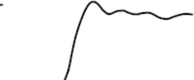
Сигнал с длинным проводом заземления
