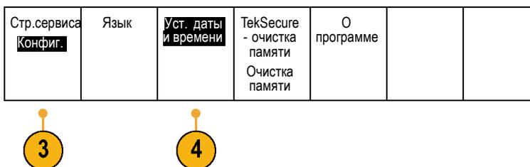
5. Нажмите кнопки на боковой панели и поверните оба многофункциональных регулятора (**A** и **B**), чтобы установить значения времени и даты.
