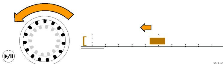
При дальнейшем повороте ручки панорамирования влево интервал регистрации РЧ-сигнала и временное положение спектра будут перемещаться синхронно вплоть до левого края экрана. Когда правая граница интервала регистрации РЧ-сигнала достигает индикатора синхронизации, размещенного вверху экрана, сдвигать этот интервал дальше влево невозможно. Интервал регистрации РЧ-сигнала должен сохранять привязку к моменту запуска.
