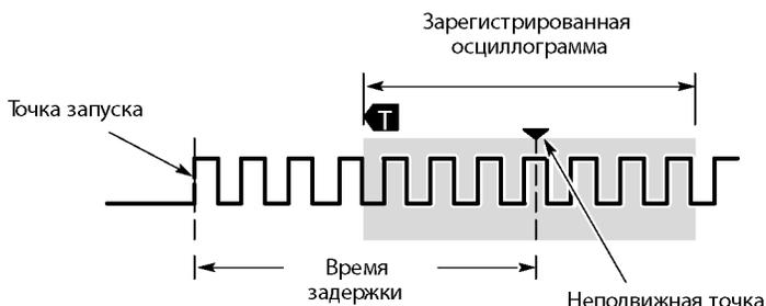
Установив кнопку **Delay** в положение **Вкл**, поверните регулятор **Положение по горизонтали** против часовой стрелки, чтобы увеличить задержку. Точка запуска переместится влево и выйдет за границу зарегистрированной осциллограммы. Затем можно повернуть регулятор **Масштаб по горизонтали**, чтобы более подробно просмотреть нужный участок в центре экрана.
