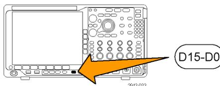
6. Для включения или отключения меню «D15 - D0» нажмите на нижней панели кнопку **D15 - D0**.
