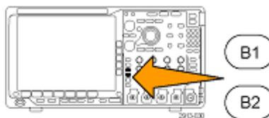
2. Чтобы создать метку, например для канала 1 или шины B1, нажмите кнопку нижнего экранного меню.
