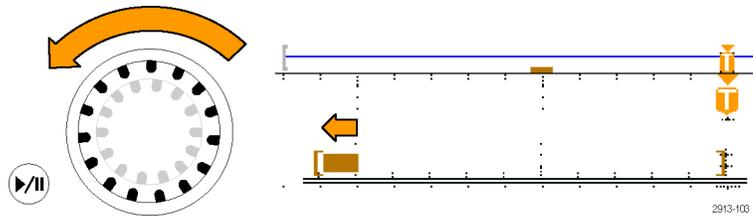
Когда осциллограф не выполняет сбор данных (остановлен), интервал регистрации РЧ-сигнала фиксируется на дисплее. Поворот ручки панорамирования по часовой стрелке или против часовой стрелки не приведет к изменению положения интервала регистрации РЧ-сигнала. Вместе с тем поворот ручки панорамирования будет влиять на положение спектра в пределах интервала регистрации РЧ-сигнала.
