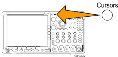
В нашем примере на выбранной осциллограмме появятся два вертикальных курсора. При повороте многофункционального регулятора **a** один из курсоров перемещается влево или вправо. При повороте регулятора **b** перемещается другой курсор.
