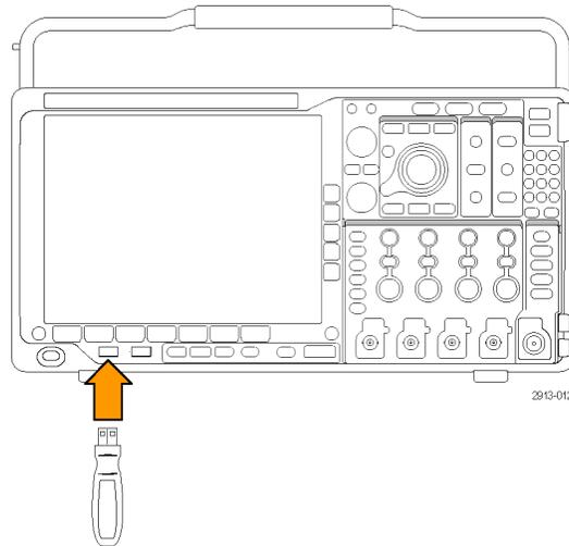
4. Включите осциллограф. Прибор автоматически распознает обновление микропрограммного обеспечения и установит его.
