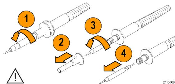
Перед использованием пробника надежно затяните изолятор и новый наконечник.
