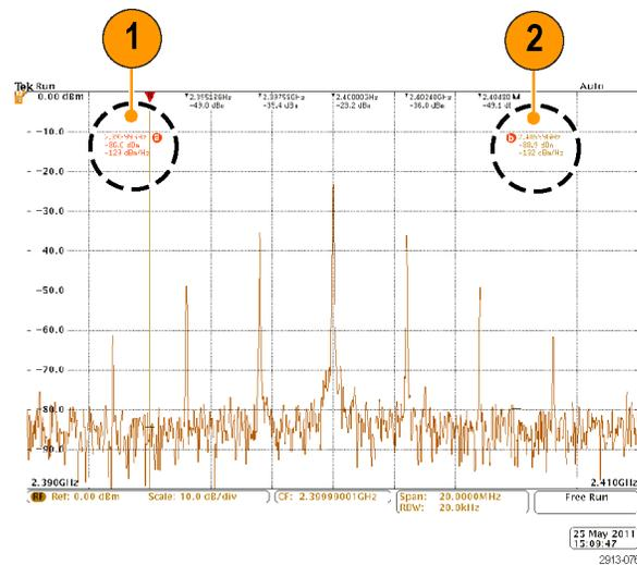
3. Показания типа «дельта» для частот и амплитуд размещаются в верхней части экрана.
