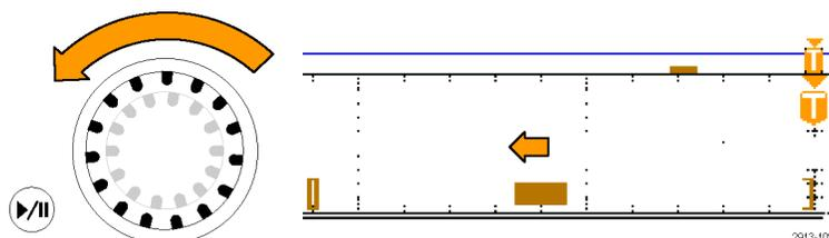
Если продолжить поворачивать ручку панорамирования против часовой стрелки, временное положение спектра будет перемещаться влево вплоть до касания левого края интервала регистрации РЧ-сигнала.
