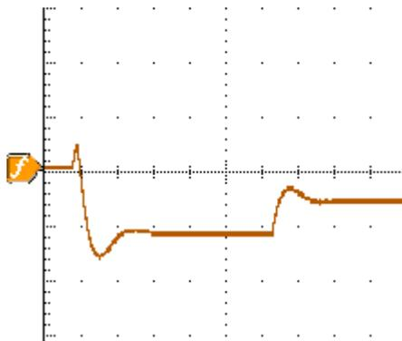
Используйте шумоподавление для устранения (отключения отображения) информации о частоте и фазе, когда амплитуда РЧ-сигнала ниже заданного пользователем значения. Таким образом можно избежать отображения широкополосного шума на зависимостях частоты и фазы от времени в случае отсутствия сигнала на РЧ-входе.
