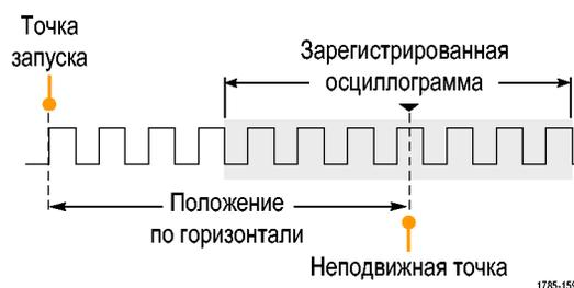
1. Положение (время задержки) устанавливается ручкой **Положение по горизонтали**.
