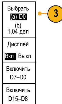
4. Поверните многофункциональный регулятор **A**, чтобы выбрать канал для перемещения.
