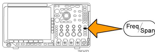
2. В боковом меню выберите пункт **Центральная частота** и используйте многофункциональную ручку **a** или цифровую клавиатуру осциллографа для ввода требуемой центральной частоты. При вводе с цифровой клавиатуры можно также использовать пункты результирующего бокового меню для выбора единиц измерения.
