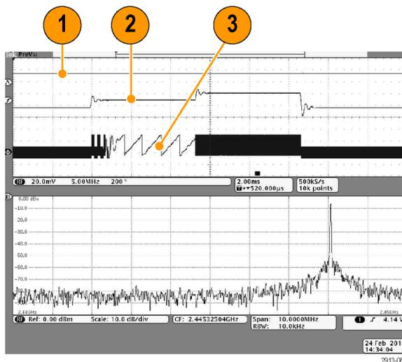
Все перечисленные виды зависимостей строятся на основе данных IQ временной области, полученных из входного РЧ-канала. Для данных зависимостей проводится корреляция по времени с другими аналоговыми и цифровыми каналами для формирования непрерывного потока данных временной области.
