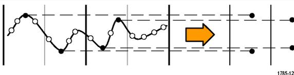
В режиме **Высокое разрешение** рассчитывается среднее значение по всем выборкам для каждого интервала оцифровки. Этот режим также применяется только для неинтерполируемой выборки в режиме реального времени. Обеспечивается более высокое разрешение сигнала, но с меньшей шириной полосы пропускания.
