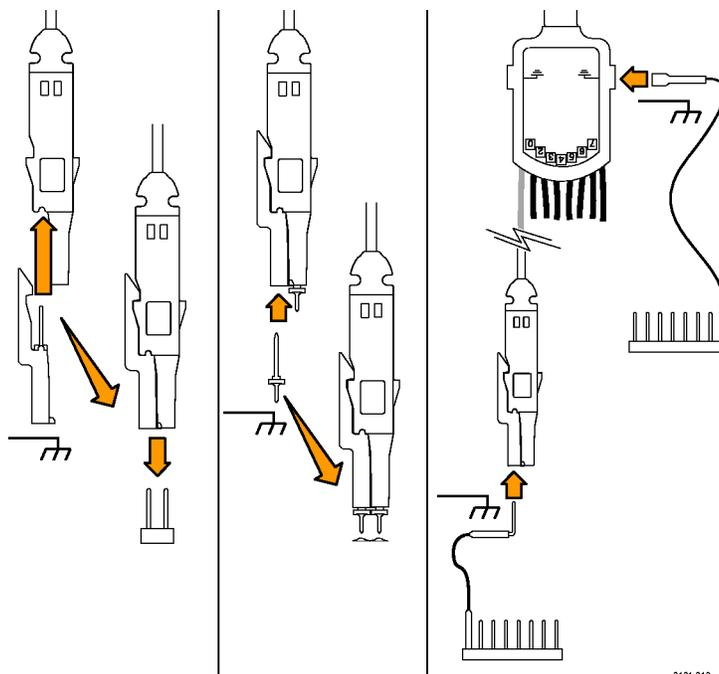
2. Подсоедините провод (или провода) заземления к цепи заземления.
