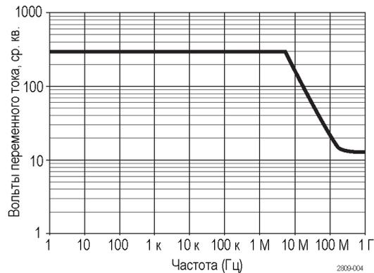
При проведении измерений в режиме изоляции от цепей заземления пользуйтесь приведенной выше кривой снижения параметров опорного вывода.
