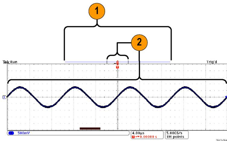
**ПРИМЕЧАНИЕ.** Если при работе с частотной областью с включенной функцией автоувеличения переместить участок спектра за пределы видимого фрагмента регистрации временной сетки, то во временной области исчезнет оранжевая полоса, указывающая на временную метку спектра, а также исчезнут динамические показатели в частотной области.
