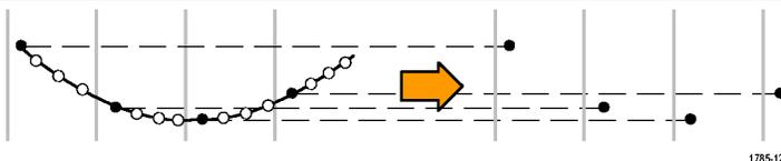
В режиме **Пиковое детектирование** используются максимальное и минимальное значения из всех выборок, содержащихся в двух последовательных интервалах оцифровки. Этот режим применяется только для неинтерполируемой выборки в режиме реального времени. Он полезен для захвата высокочастотных выбросов.
