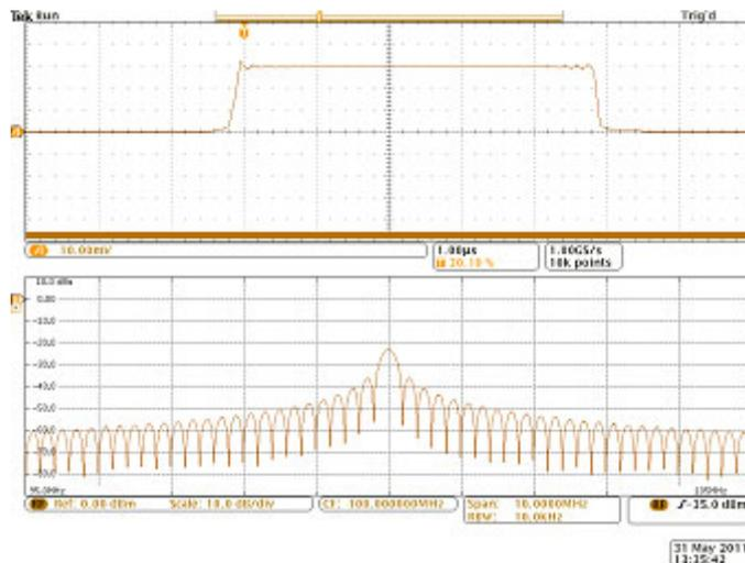
На рисунке справа уровень синхронизации по фронту мощности увеличен до  $-10$  дБм. Индикация при синхронизации теперь смещена относительно начала пакета приблизительно на  $500$  нс. Это является следствием задержки в детекторе мощности, о которой упоминалось выше.
