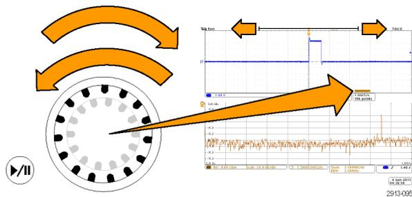
Поворот регулятора панорамирования во время регистрации данных осциллографом приводит к перемещению положения спектра и интервала регистрации РЧ-сигнала одновременно. Данная операция работает так, как если бы вы перемещали интервал регистрации РЧ-сигнала вдоль оси времени параллельно с положением спектра.
