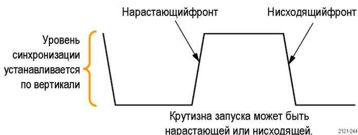
На координатной сетке осциллографа отображается длинная горизонтальная линия (или несколько линий), отображающая уровень синхронизации.
