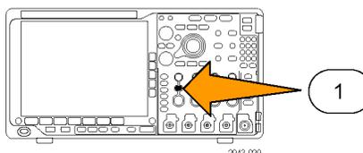
Чтобы выполнить автоустановку цифрового канала, подключите логический пробник, затем выберите входной канал. (См. стр. 81, *Настройка цифровых каналов*.)
