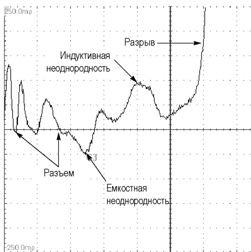
Рис. 13: Осциллограмма TDR для примера с неоднородностями в микрополосковой линии
