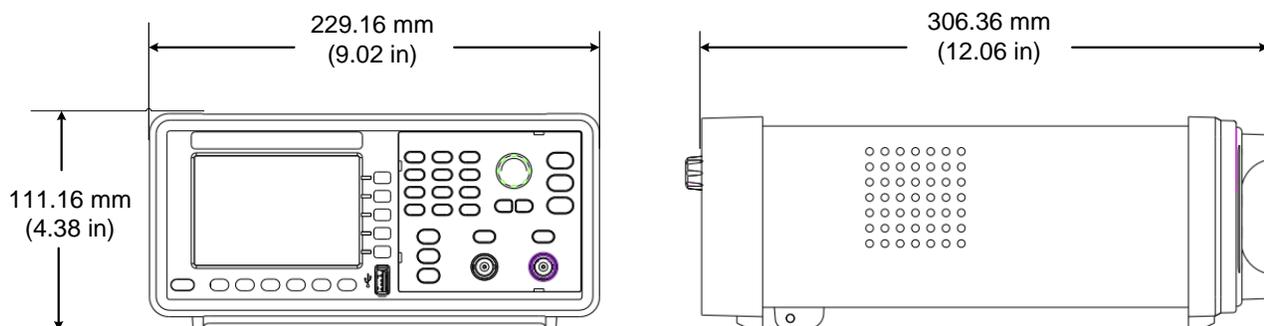
Рис. 1. Размеры прибора
