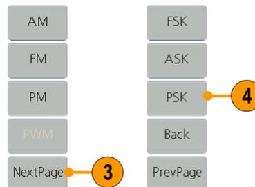
5. На экране появится окно настройки параметра PSK. В качестве источника фазовой манипуляции выберите **Internal** (Внутренняя) или **External** (Внешняя).
