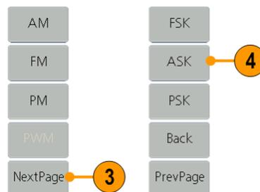
5. На экране появится окно настройки параметра ASK. В качестве источника амплитудной манипуляции выберите **Internal** (Внутренняя) или **External** (Внешняя).
