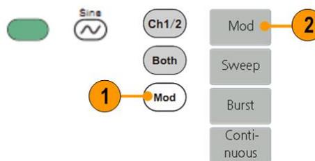
**Примечание.** Вы можете выбрать только синус, квадрат, пилу или произвольный сигнал в качестве сигнала несущей.
