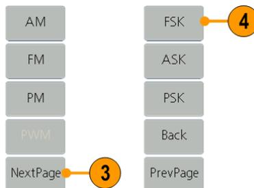
5. На экране появится окно настройки параметра FSK. В качестве источника частотной манипуляции выберите **Internal** (Внутренняя) или **External** (Внешняя).
