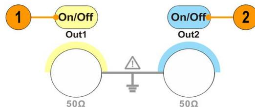
Светодиод включается, когда соответствующая кнопка канала находится во включенном состоянии.
