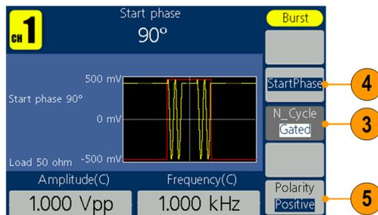
5. Нажмите кнопку **Polarity** (Полярность), чтобы установить полярность стробированного пакетного сигнала.
