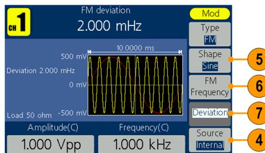
7. Нажмите кнопку **Deviation** (Отклонение), воспользуйтесь ручкой общего назначения, чтобы настроить отклонение, или используйте цифровую клавиатуру, а затем выберите единицы.
