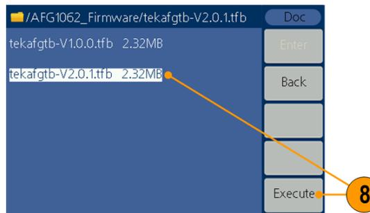
**Примечание.** Имя файла прошивки следующий вид: *tekafg1022-Vx.x.x.tfb* или *tekafg1062\_Vx.x.x.tfb*.
