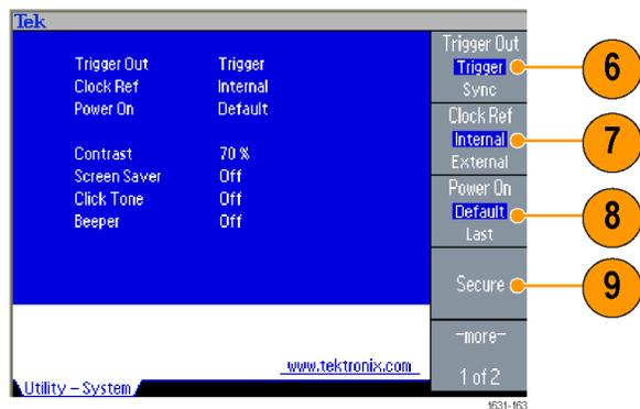
10. -more-(次へ)ボタンを押すと2 ページ目を表示。Contrast (コントラスト)を押して画面のコントラストを調整。
