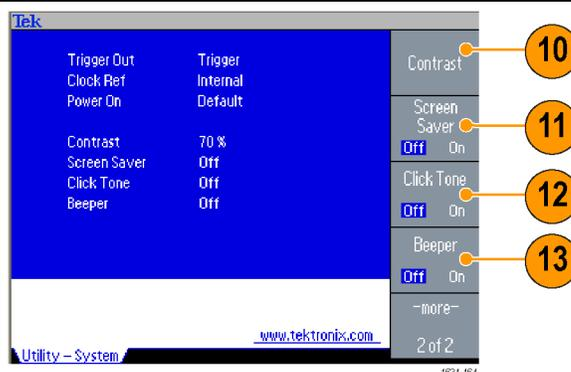
11. Screen Saver (スクリーン・セーバ)を押して、スクリーン・セーバのオン/オフを切り替える。
