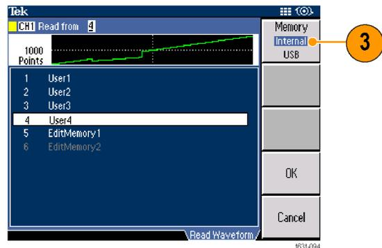
**注:** Edit Memory 2 (波形メモリ2) は 2 チャンネル機種でのみ使用可能です。Edit Memory 1 (波形メモリ1) はチャンネル 1 に、Edit Memory 2 (波形メモリ2) はチャンネル 2 に対応します。
