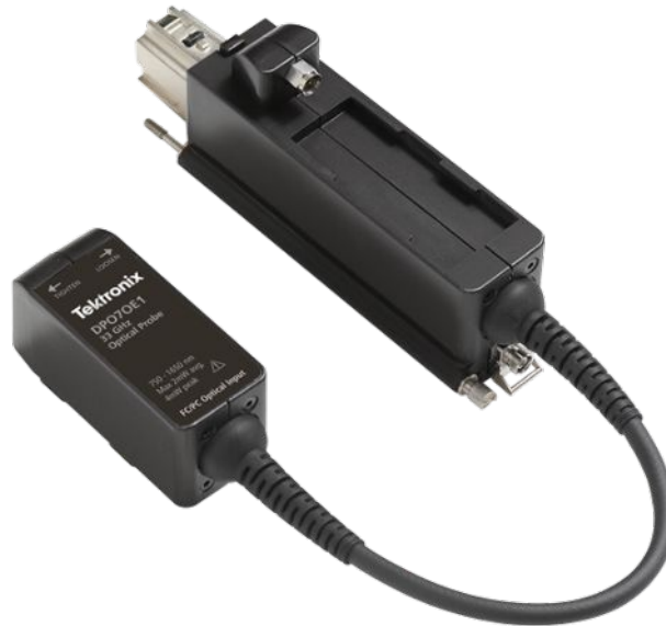
図 2: DPO70E1 型(シャトルをキャリアから取り外した状態)
