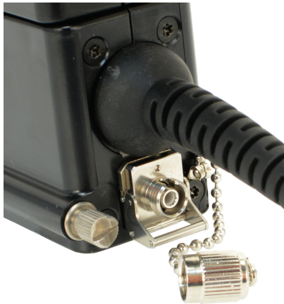
図 9 : 光コネクタから金属製防塵キャップを取り外す
