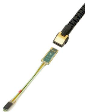
说明：除 TriMode 输入端和 TekFlex 触点外，在 P77STCABL 端部上没有暴露的金属表面。
