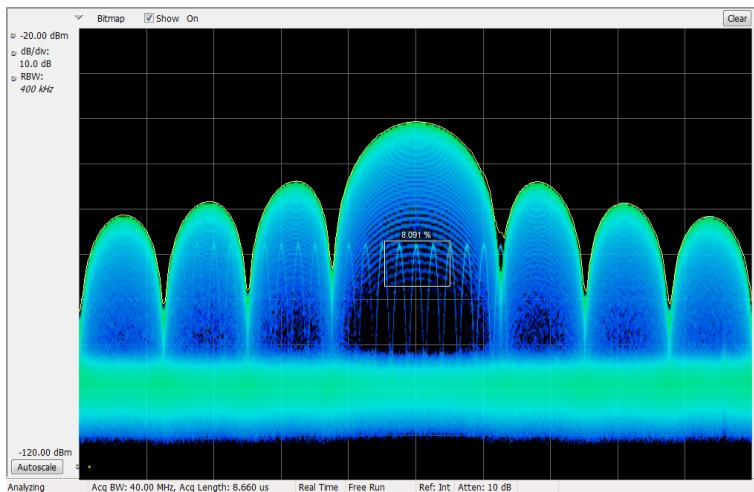
Если ожидается, что сигнал будет непрерывным, и нужно зарегистрировать события его скачкообразного перехода на другую частоту или на более низкую амплитуду, расположите измерительное окно Density (плотность) так, чтобы оно охватывало пик сигнала, выберите условие **Lower** (ниже) для элемента управления Density (плотность) и задайте значение **Threshold** (порог) равным 100 %. Прибор выполнит синхронизацию, когда сигнал исчезнет из измерительного окна.
