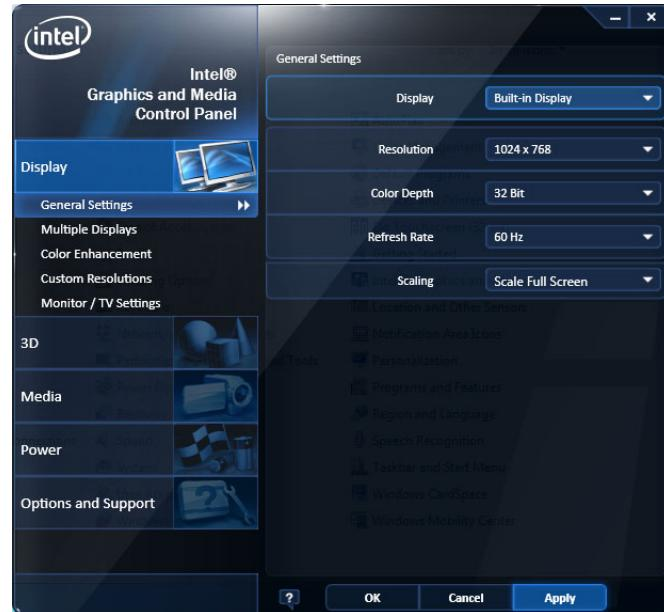
**ПРИМЕЧАНИЕ.** Можно подключить второй монитор после включения анализатора; однако после подключения также потребуется включить Extended Desktop в панели управления драйвером Intel Extreme Graphics 2M.
