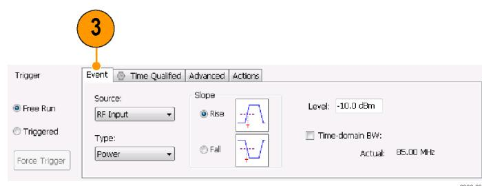
4. Используйте вкладку Time Qualified (временные параметры) для установки параметров, определяющих события синхронизации на основе их длительности.
