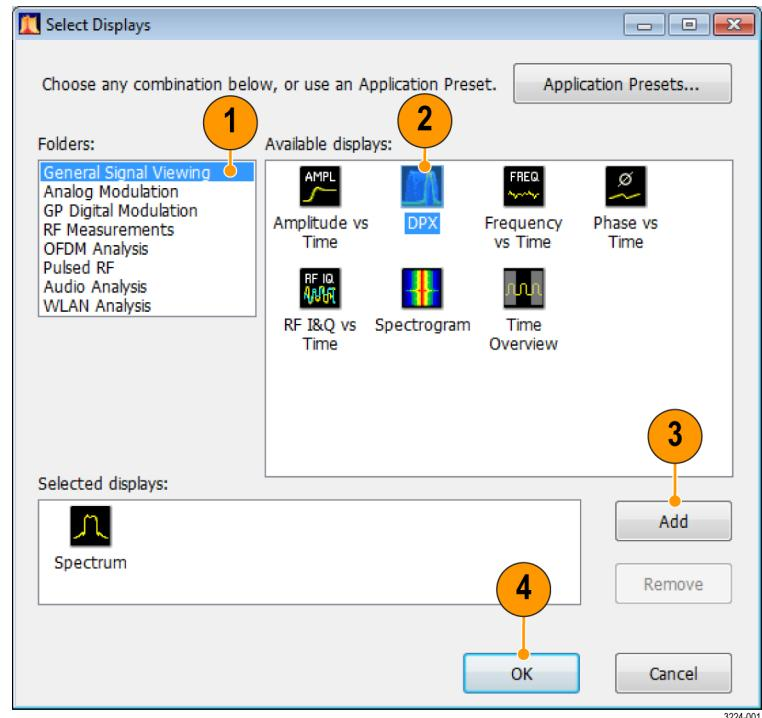
**Использование предварительной установки приложения.** Выберите экраны из предварительных установок своего приложения.
