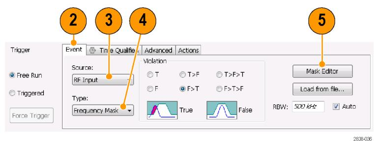
Редактор масок открывается с осцилограммами экрана Spectrum (Спектр) в графическом окне.
