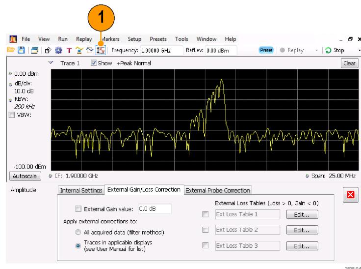
3. Чтобы использовать постоянный коэффициент коррекции, установите флажок **External Gain value** (Коэффициент усиления внешней аппаратуры). Введите значение в текстовое поле.
