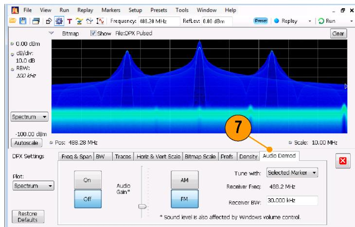
8. Нажмите кнопку **On** (Вкл.), чтобы включить функцию демодуляции аудиосигнала.
