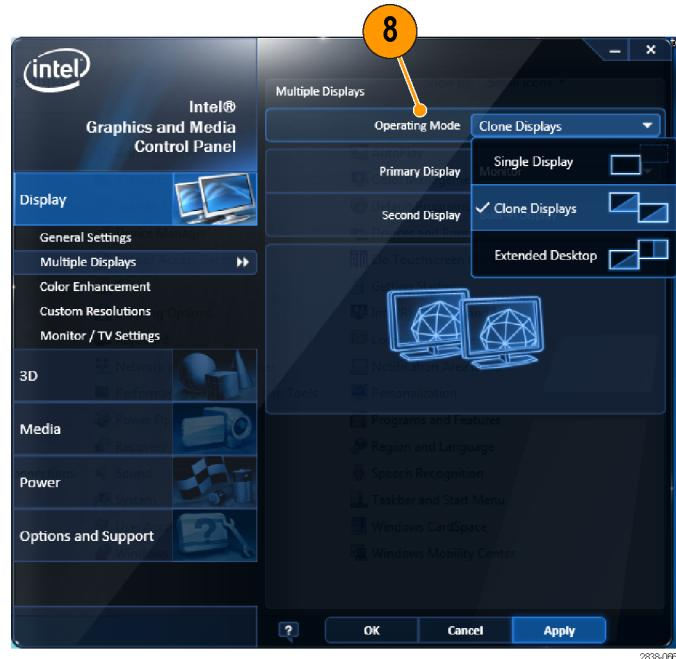
9. При выборе **Extended Desktop** (расширенный рабочий стол) не забудьте установить значение **Positioning** (положение), чтобы выровнять друг относительно друга два экрана рабочего стола.
