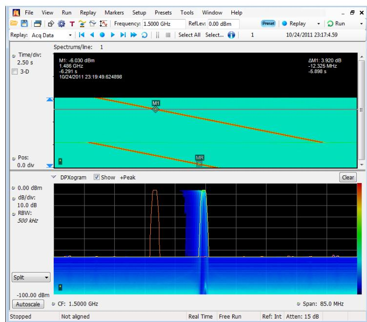
В этом примере показано окно с двумя экранами: экран отображения спектра и экран со спектром DPX.
