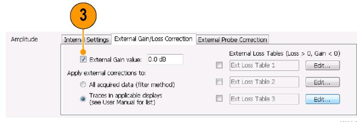
4. Чтобы использовать таблицу для коррекции данных с учетом значений усиления или потерь, зависящих от частоты, установите флагок **External Loss Tables** (Таблицы внешних потерь).
