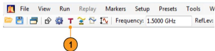
2. Ниже показаны действия для задания параметров синхронизации, для чего следует щелкнуть одну из вкладок в панели управления Trigger (Синхронизация).
