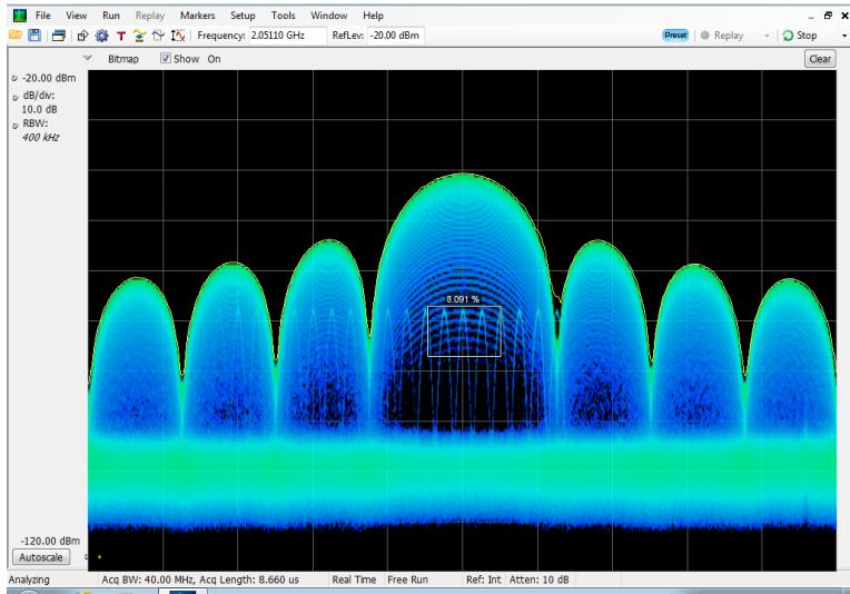
如果预计信号是一个连续音调，并且希望在其跳到其他频率或下降到一个较低幅度时捕获相应事件，请将 Density (密度) 测量框移到信号峰值处，在 Density (密度) 控件中选择 Lower (低于)，并将 Threshold (门限) 设置为 100%。当信号不在该测量框中时，仪器将触发。
