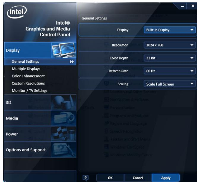
**说明：**您可以在接通分析仪的电源之后连接第二个显示器，但并不推荐您这样操作；但是，连接之后，您仍然需要在 Intel Extreme Graphics 2M 控制面板中启用 Extended Desktop (扩展桌面)。
