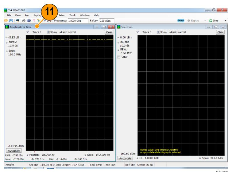
11. 将 Spectrum (频谱) 显示中的跨度减少到 25 MHz。此时，采集又成为实时方式。
