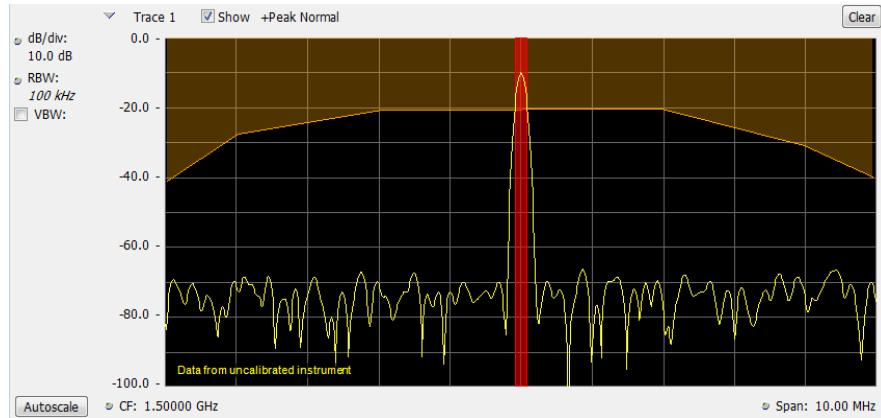
下图显示了通过噪声系数在模板之外且已启用“上部模板”的测试的结果。也使用了标记。
