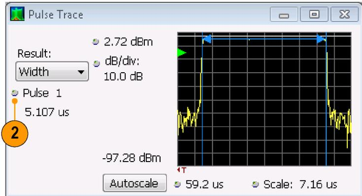
3. Для увеличения деталей выбранного импульса используйте элементы управления Scale (масштаб) и Offset (смещение). Например, можно настроить элементы управления для получения подробного представления результатов измерения времени нарастания импульса, как показано на рисунке.
