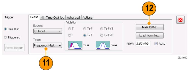
13. Используйте диалоговое окно Mask Editor (редактор масок) для создания маски для вашего сигнала. Начните с использования функции **Auto draw** (автоматическое построение) и при необходимости выполните подгонку. Осциллограммы, выбранные на экране анализатора спектра, используются в редакторе масок в качестве опорных. Доступны все параметры обнаружения и функции кривых.
