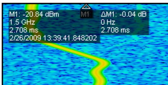
11. При помощи мыши переместите маркер MR на экране *Spectrogram* (спектрограмма) в требуемую точку. При перемещении маркера вверх и вниз наблюдайте за соответствующими изменениями его положения на экране *Spectrum* (спектр). Предустановка приложения *Time-Frequency Analysis* (частотно-временной анализ) сконфигурировала экран *Spectrum* (спектр) для отображения выбранной линии спектрограммы.
