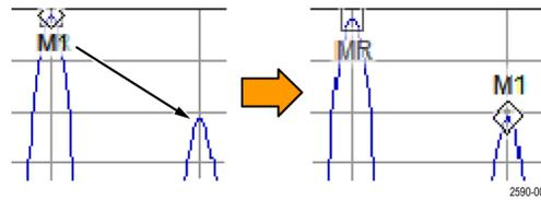
Показания, отображаемые в верхней правой части экрана, представляют собой разницу между опорным маркером **MR** и маркером приращения **M1** для частоты и амплитуды.
