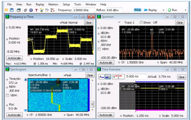
На экране *Frequency vs Time* (временная зависимость частоты) по вертикальной оси откладывается отклонение частоты от среднего значения, а по горизонтальной оси – время.
