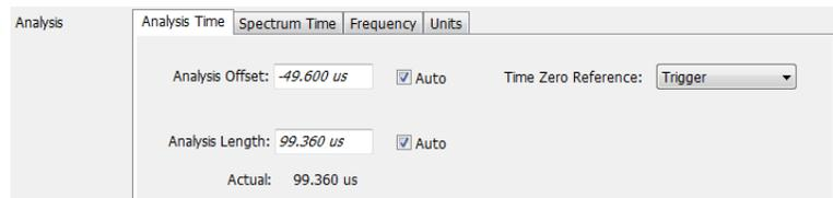
13. Для параметра **Time Zero Reference** (нулевое опорное значение времени) установите значение **Acquisition Start** (запуск регистрации).
