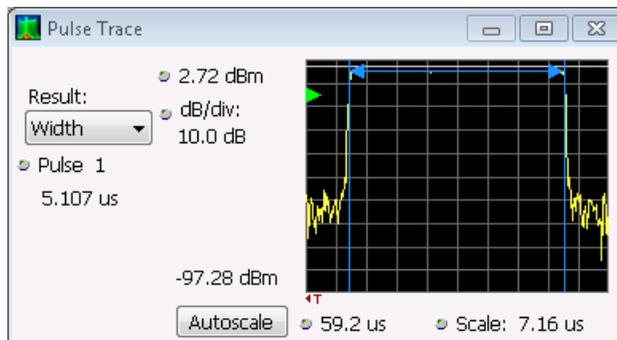
2. Щелкните на экране Pulse Trace (кривая импульса) элемент управления Pulse (импульс) и введите другой номер импульса. Новый импульс появляется на экране Pulse Trace (кривая импульса) и выбирается на экране Pulse Table (таблица импульсов). Для просмотра и анализа результатов измерений импульсов можно использовать экраны Pulse Trace (кривая импульса) и Pulse Table (таблица импульсов) совместно.
