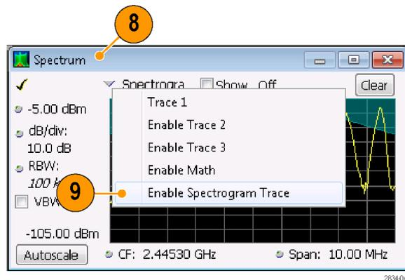
Кривая спектрограммы на экране Spectrum (спектр) соответствует строке, выбранной на экране Spectrogram (спектрограмма) активным маркером.
