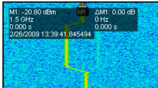
На экране *Time Overview* (временной обзор) по вертикальной оси откладывается мощность в логарифмическом масштабе, а по горизонтальной – время.
