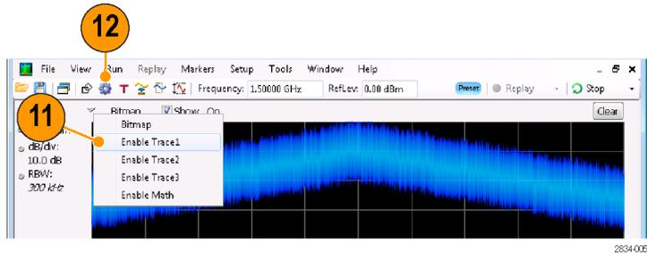
12. Щелкните значок Settings (настройки), чтобы открыть панель управления DPX Spectrum Settings (параметры спектра DPX).
