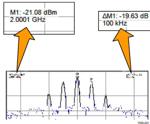
До сих пор использовались маркеры для измерений в двух точках одной и той же кривой.
