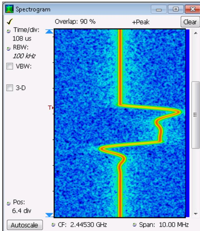
На экране Spectrogram (спектрограмма) одновременно отображаются и временная и частотная области. Вертикальная ось – это ось времени, более новые данные отображаются в нижней части спектрограммы. Горизонтальная ось – это ось частот, перекрывающая тот же диапазон частот, что и на экране Spectrum (спектр).
