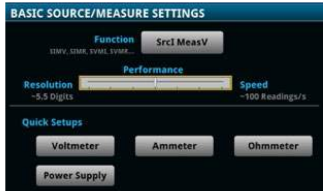
單鍵式快速設定模式可加快量測設定並有效地縮短量測時間。
