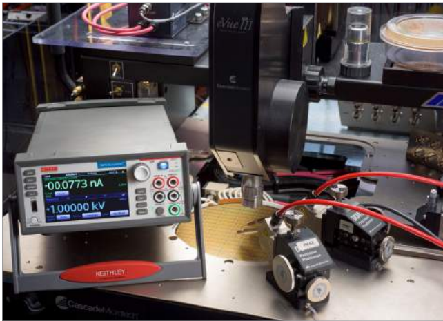
使用多部 SMU 儀器在晶圓或封裝電晶體上分析電晶體的特性
