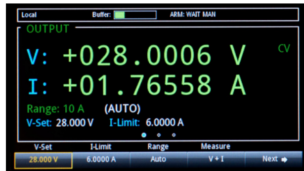
圖 3. 從首頁畫面調整電壓、電流、電流範圍、量測模式、保護等級和其他功能。
