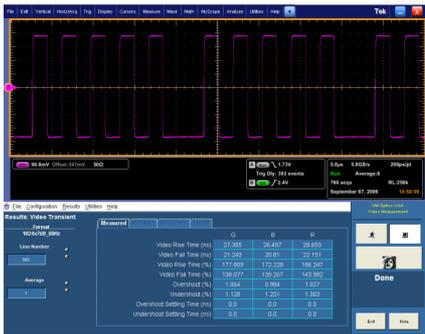
▶ RGB 일시 응답 측정 결과(VGA 옵션)
