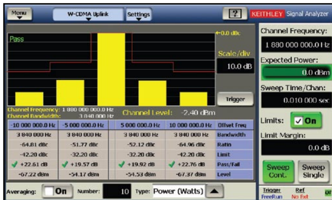
図8. 隣接チャンネルパワー比機能を使用して、規格に基づかない信号の試験パラメータと試験リミットを定義します。
