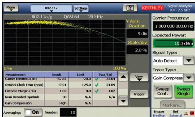
図6. ケースレー独自の測定および表示技術を使って、OFDM信号のゲイン圧縮が明確に視覚化されています。
