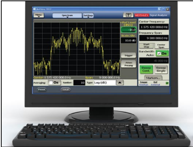
図2. 2820A型デスクトップ・コントロールパネル・ソフトウェアを表示したPCのディスプレイ。このソフトウェアによって、PCと信号捕獲や計算を行うハードウェアを直接接続できるため、大量のI-Qデータの高速な信号処理が可能なPCに迅速に転送できます。
