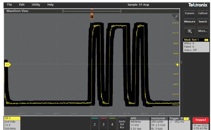
高品質なリファレンス信号に基づくリミット・マスク・テスト
