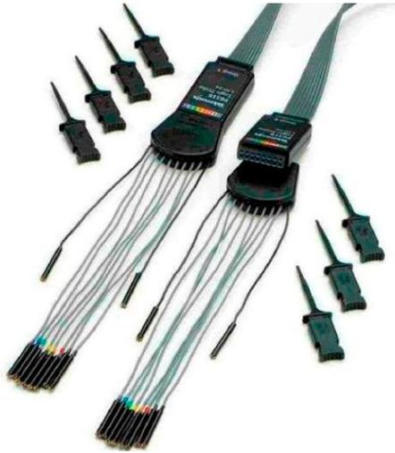
P6316 型デジタル・プローブには 2 組の 8 チャンネル・ポッドが付属しており、デバイスに簡単に接続可能
