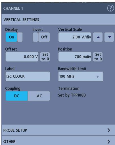
ディスプレイ上の目的のアイテムをダブルタップするだけで構成メニューが表示される。この例では、チャンネル・バッジがダブルタップされたので、チャンネル構成メニューが表示されている。メニューは、メニュー以外の場所をタップするだけで簡単に消去できる。
