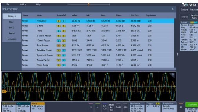
電源品質測定結果。パワー解析オプションにより、パワー回路のパラメータを簡単に、正確に測定可能
