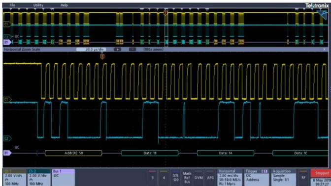
I<sup>2</sup>Cバスの特定のアドレスおよびデータの packets にトリガした例。黄色の波形はクロック、青色の波形はデータ。バス波形は、スタート、アドレス、読み取り／書き込み、データ、ストップなど、デコードされた packets の内容を表示
