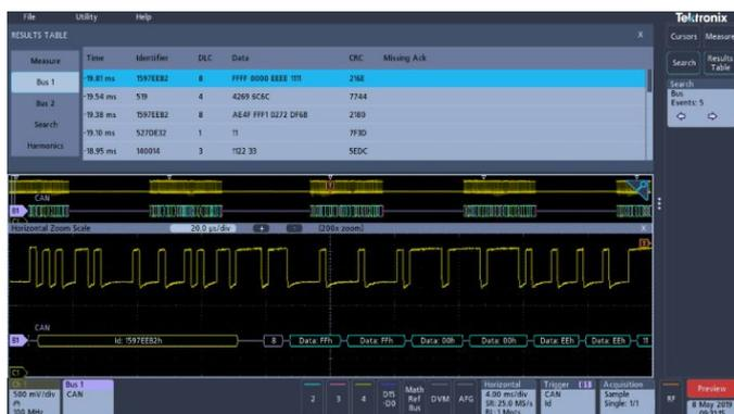
イベント・テーブル表示では、ロング・メモリに取込まれたすべての CAN パケットの識別子、DLC、データ、CRC が、トリガからの時間表示とともに表示される
