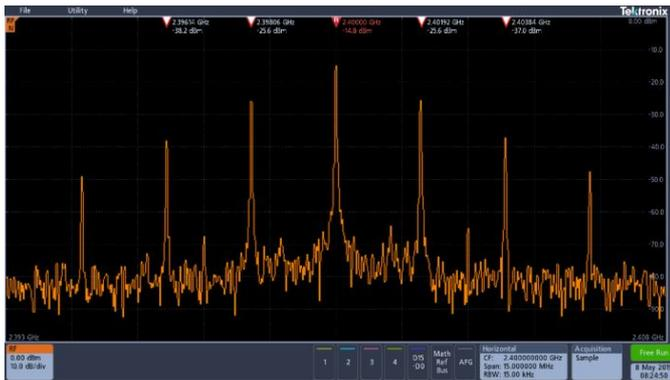
自動ピーク・マーカにより、重要な情報が一目でわかる。この例では、設定したスレッシュホールド／範囲条件に合った5つの振幅ピークに自動的にマーカが付いている。また、それぞれのピークにおける周波数と振幅も表示される
