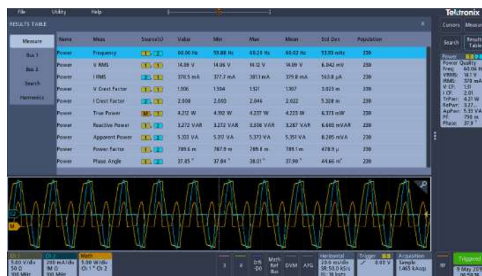
電源品質量測表。自動電源量測可快速且準確地分析一般功率參數。
