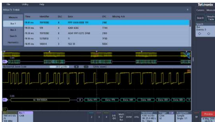
事件表顯示長擷取中每個 CAN 封包的解碼識別碼、DLC、DATA 與 CRC。
