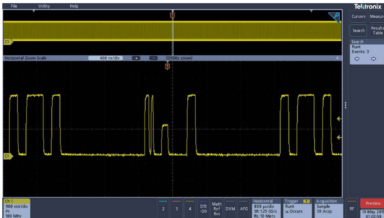
FastAcq 協助找出數位資料串中的矮波脈衝，以供進一步調查。在此測試案例中，「搜尋」在 10 M 點擷取中找到並標記 3 個矮波脈衝。
