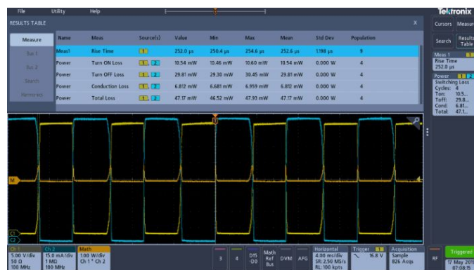
开关损耗测试
