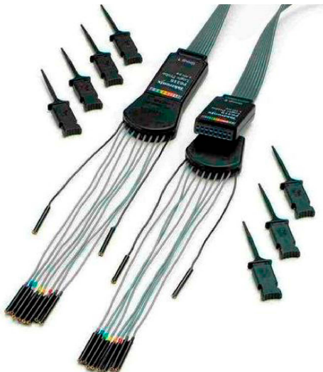
P6316 型デジタル・プローブには2組の8チャンネル・ポッドが付属しており、デバイスに簡単に接続できます。
