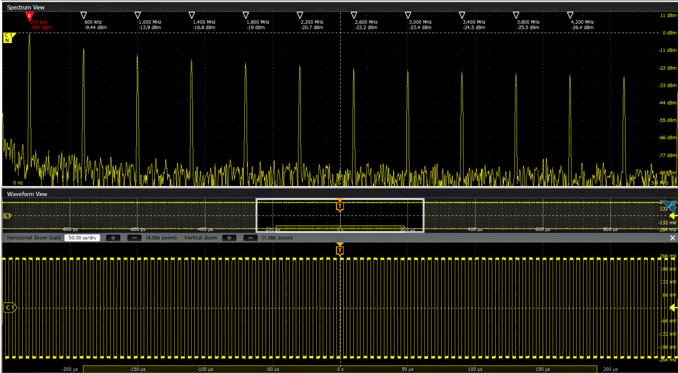
스펙트럼 시간은 FFT가 계산되는 시간의 범위를 제어합니다. 시간 도메인 보기에서 작은 직사각형 그래프로 나타내는 스펙트럼 시간은 시간 도메인 파형과의 시간 상관관계를 제공하도록 위치할 수 있습니다. 혼합 도메인 분석을 실시하기에 최적입니다. 최대 11개 자동 피크 마커가 각 피크의 주파수 및 진폭 값을 제공합니다. 참조 마커는 항상 최고 피크로 표시되며 빨간색으로 표시됩니다.
