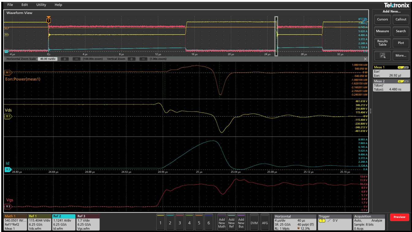
이 이미지는 역 복구 전류 및 높은 쪽에서 캡처된 전압과 더불어 다이오드 역복구 측정치를 보여줍니다.
